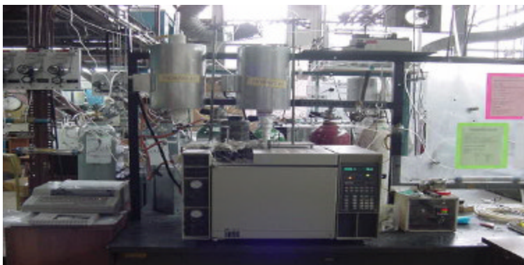
Figura No. 27: Equipo empleado para la hidrogenación de tolueno
