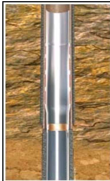
Fig. 3-12 Unión entre el ELH™ y el “liner”
