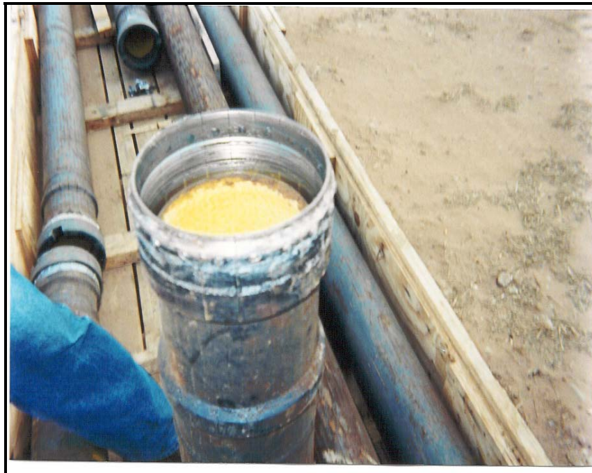
Fig.3-21b Recubrimiento interno de Poliuretano
