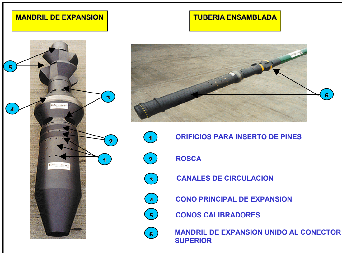
Fig. 3-22 Mandril de Expansión y Conector Superior
