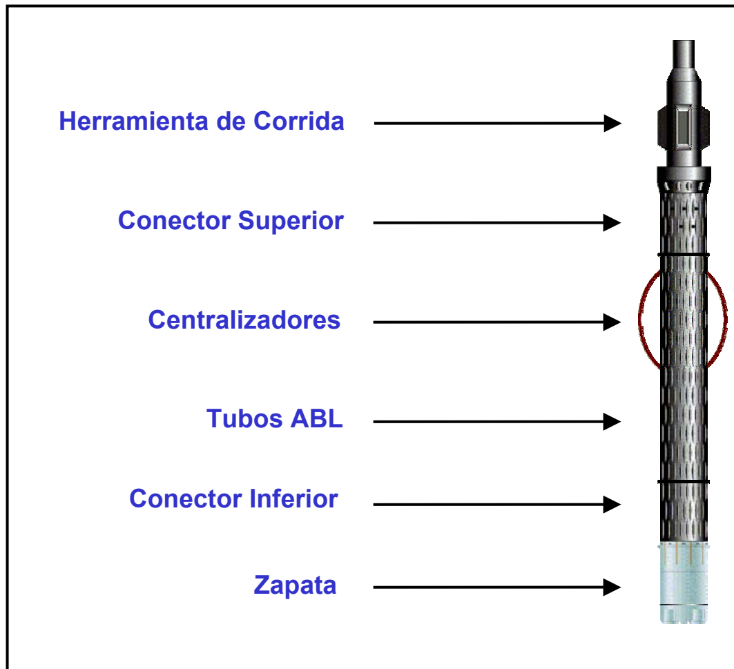
Fig. 3-23 Ensamblaje de un Sistema de Tubería Ranurada Expansible
