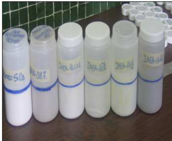
Figura 4.4: Materiales de referencia certificados en envases de polietileno de alta densidad de 1L de capacidad y altura de muestra de 7,2 cm
