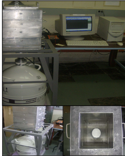
Figura 4.5: Disposición del detector gamma para la medición de muestras en laboratorio.
