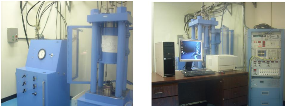
Figura 36. Sistema AutoLab2000: Plataforma de ensayos (Izquierda), Consola electrónica y sistema computarizado (Derecha).
