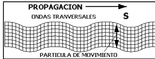
Figura 20. Onda S. La figura muestra el movimiento del medio en la dirección perpendicular a la dirección de propagación de la onda.
