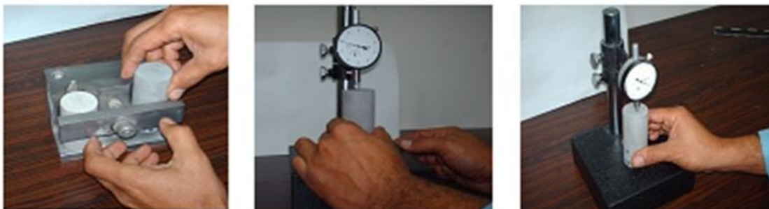
Figura 32. Secuencias de pasos para la verificación de cuadrantes en las caras transversales del tapón.
