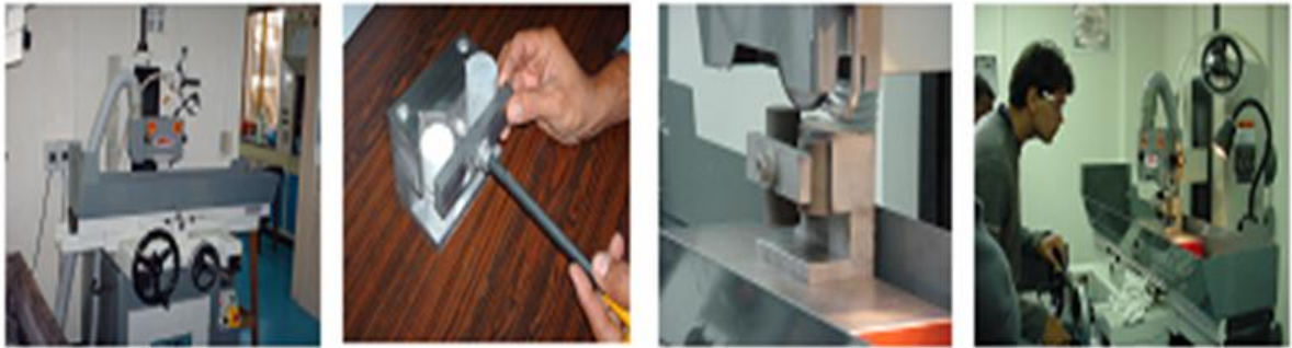
Figura 30. Secuencia de pasos para el pulido de las caras transversales con la refrentadora de superficies.
