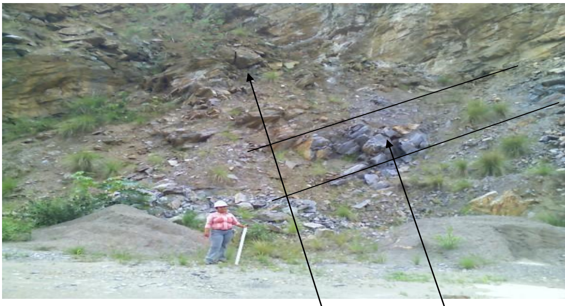
Figura 3.2. Secuencia Litológica de Esquistos y Lente de Mármol (Cota 1040 Oeste de La Mina). Fuente: Cantera Nacional C.A.
