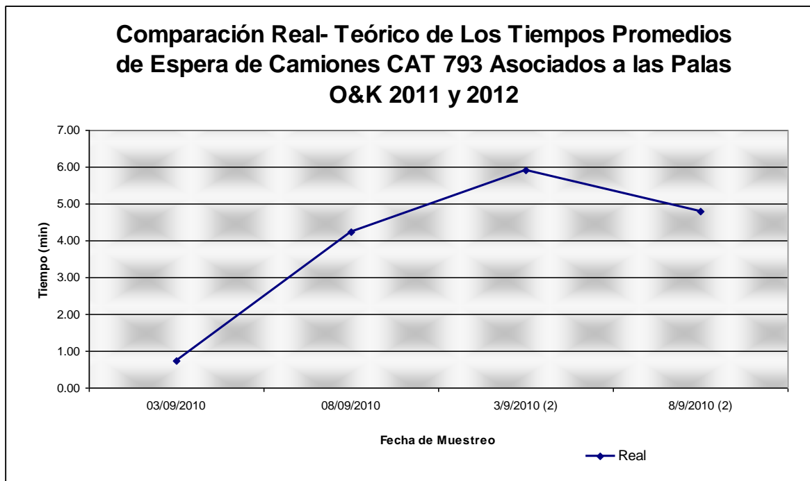
Gráfica 15. Comparación “Real”- Teórico de los tiempos promedio de espera de camiones CAT 793D asociados a las palas retro O&K RH200
