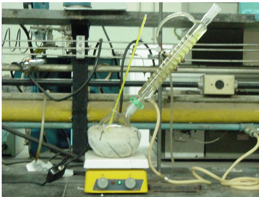
**Figura 19.** Sistema de intercambio iónico.
