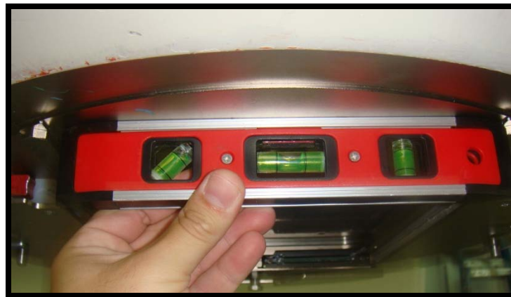
Figura 4.3 Nivelación del gantry con un nivel de burbuja
