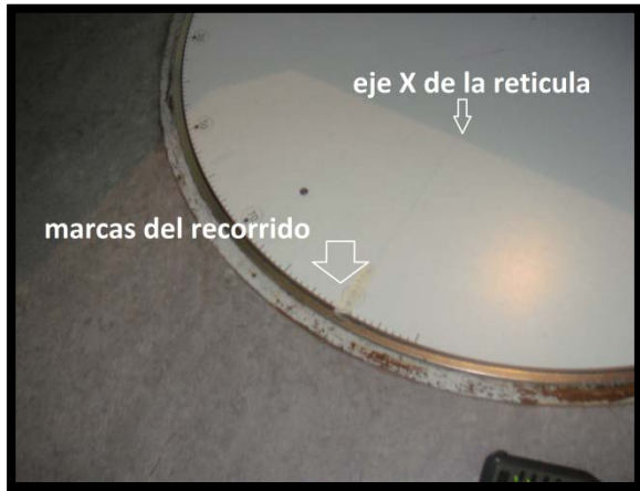
Figura 4.1 Vista en el piso para el posicionamiento del colimador
