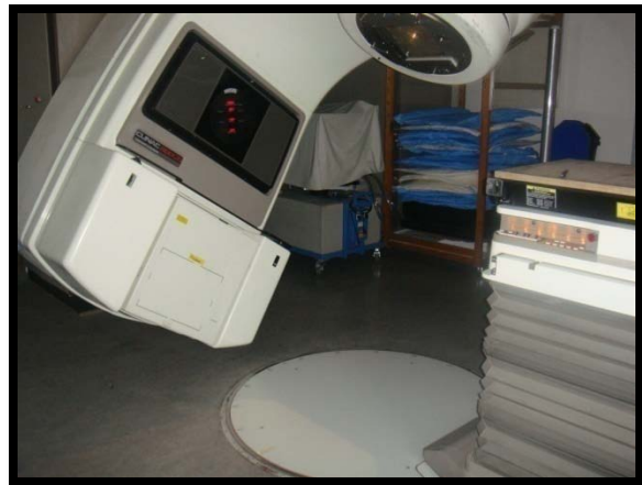
Figura 4.2 vista del gantry en estático en su movimiento de verificación del ángulo del colimador
