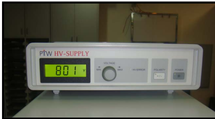
Figura 3.14 Fuente de poder externa usada con la cámara líquida
