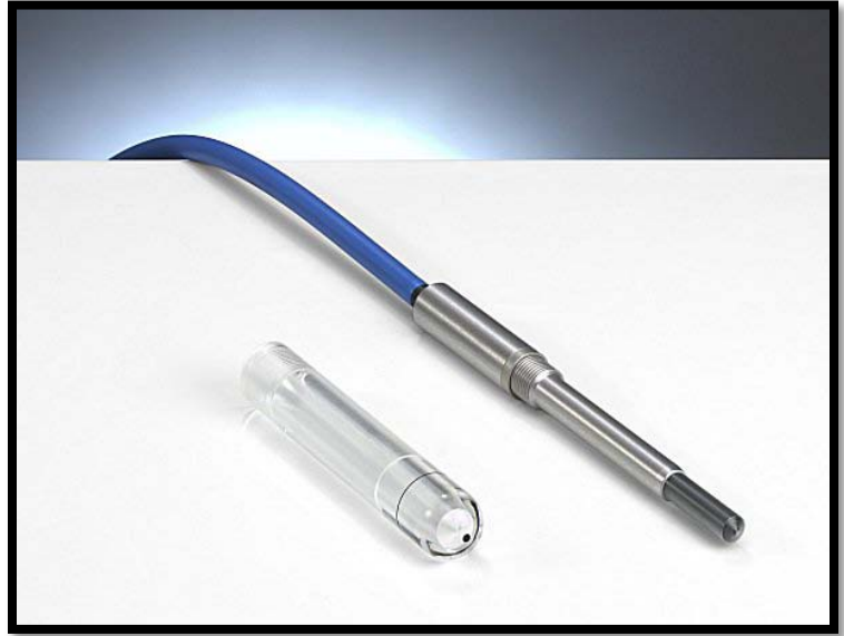
Figura 1.10 Cámara de Ionización cilíndrica tipo Farmer de 0.6 cc
