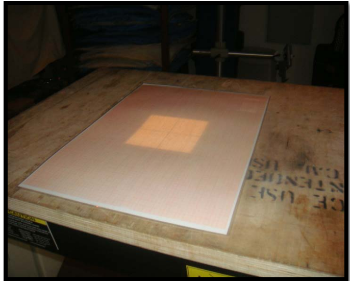
Figura 4.6 verificación del tamaño de campo luminoso
