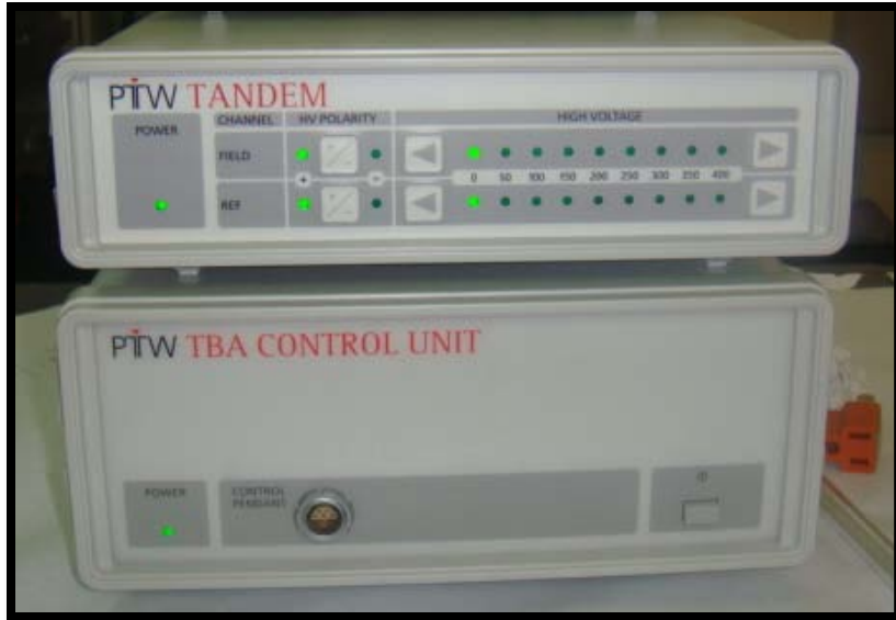
Figura 3.15 arriba Electrómetro TAMDEM, abajo unidad de control y fuente de poder del maniquí de agua MP3
