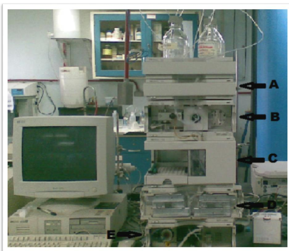
**Figura 13.- Equipo de cromatografía de líquida de alta eficiencia (HPLC) Hewlett Packard HP 1100 (Agilent Technologies)**
