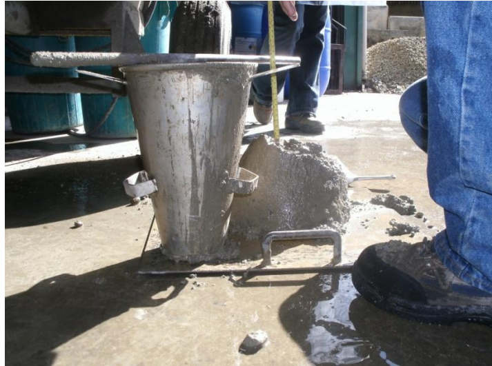
Figura II.3. Medición de Asentamiento con el Cono de Abrams. Fuente: Elaboración Propia.
