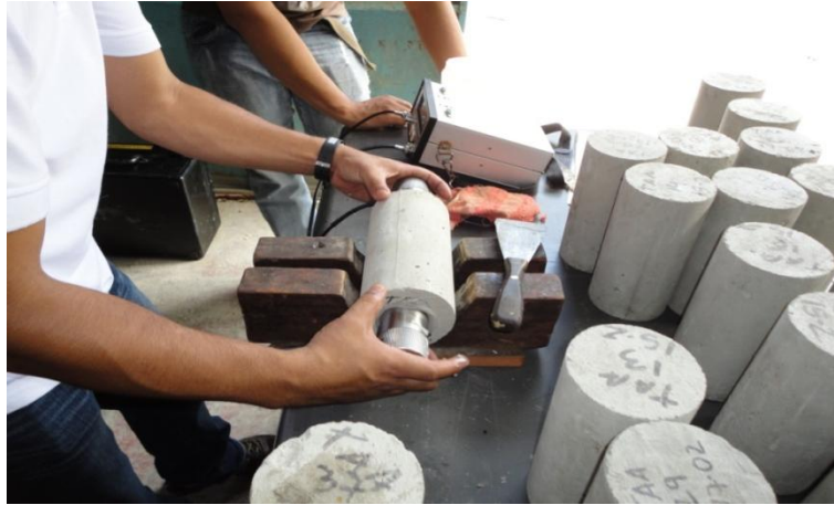
Figura II.12. Ensayo Ultrasonido. Fuente: Elaboración Propia.
