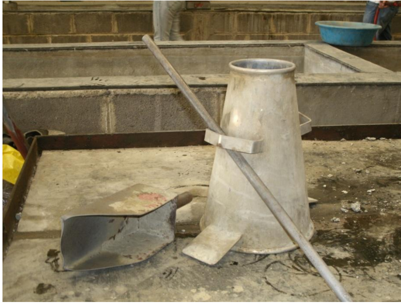
Figura II.2. Cono de Abrams. Fuente: Elaboración Propia.
