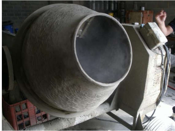
Figura III.2. Mezclado de Concreto. Fuente: Elaboración Propia.
