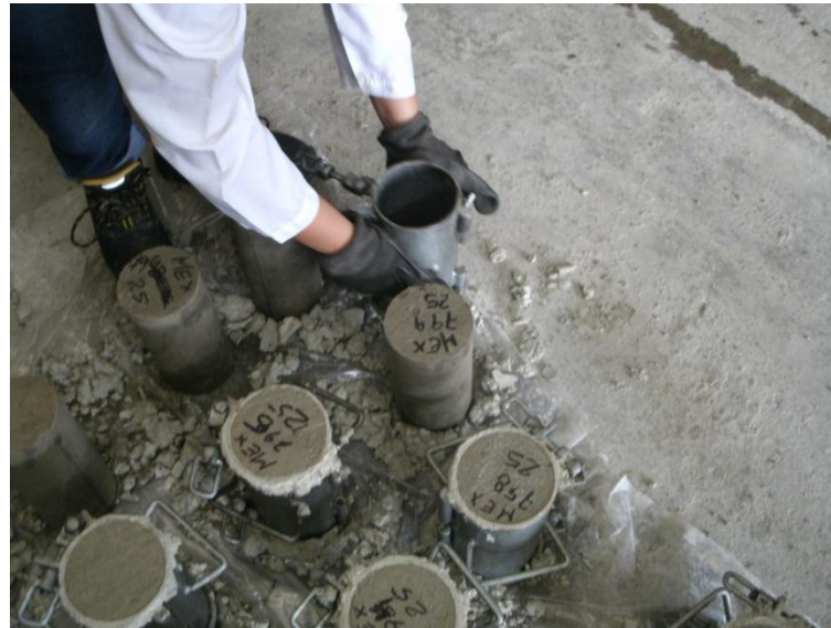
Figura III.5. Desencofrado. Fuente: Elaboración Propia.
