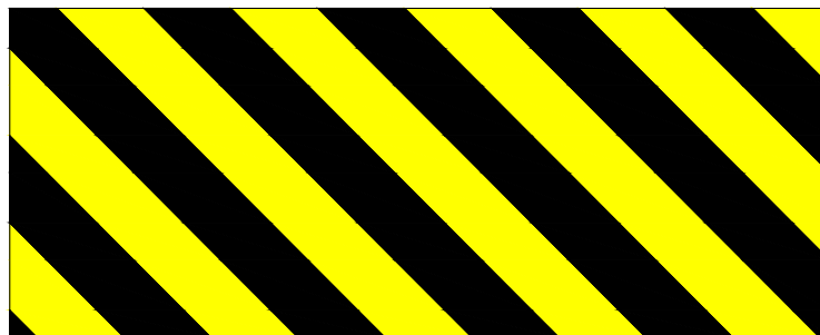
Figura 1. Ejemplo de combinación de de color de seguridad (amarillo) y color de contraste (negro).
