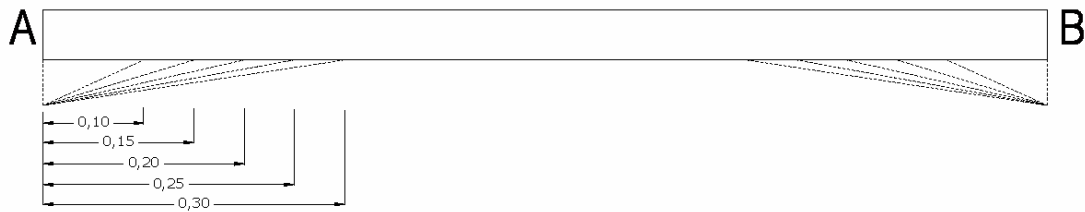
Figura 41: Viga doblemente empotrada con variaciones de cartelas.
