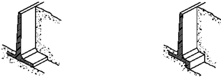
Figura II.3 Muro en Forma de T invertida, con y sin Dentellón. (Suárez D. 1998)
