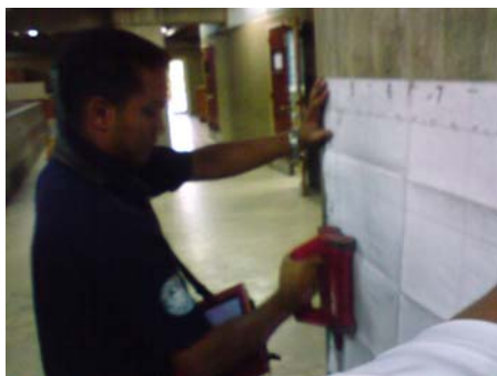
FIGURA IV.2.15 Obtención de radiografías.
