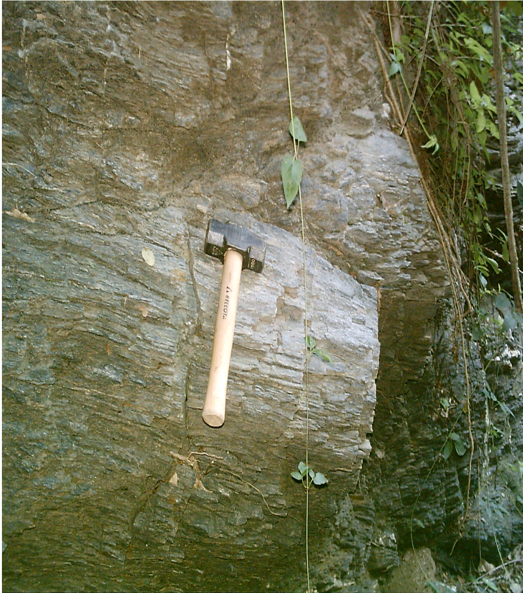
Figura #45. Evidencia del diaclasado en la quebrada Valencia, perteneciente al túnel La Encantada.
