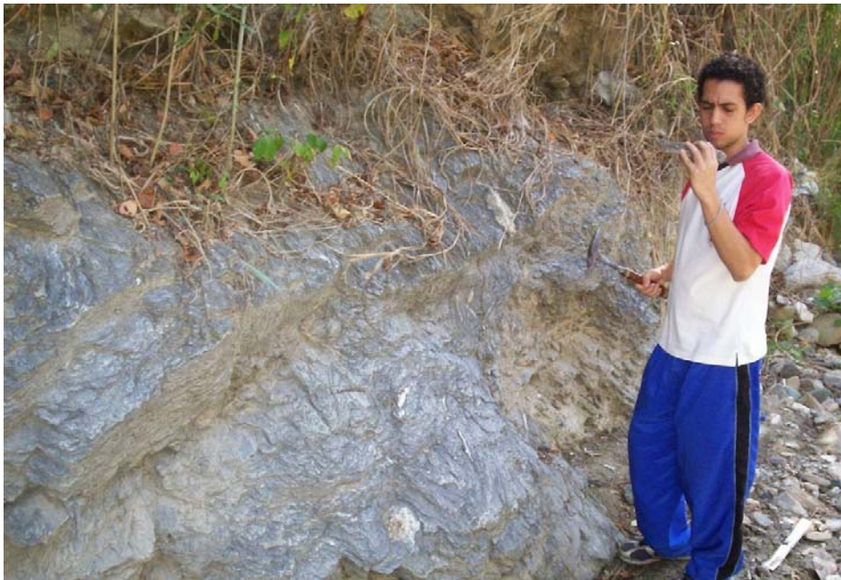
Figura #15. Afloramiento del esquistoso cuarzoso de aspecto gnéisico, muscovítico y feldespático, representativo de la unidad K1m1. Rumbo N 50° E.
