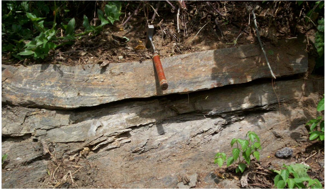
Figura #22. Afloramiento del esquistos de aspecto gnéisico cuarzo-feldespático-calcáreos, de la unidad K1m3 (g). Rumbo N 65° E.
