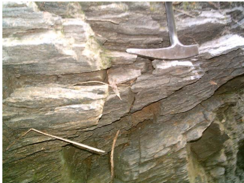
Figura #27. Afloramiento del esquistos cuarzo micáceo, representativo de la unidad K1m5. Rumbo N 55° E.
