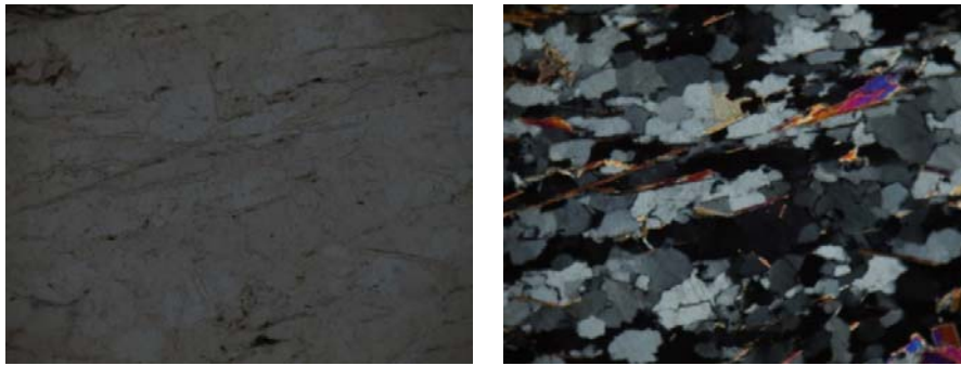
Figura #19. Cristales de muscovita orientados intercalados con cristales de cuarzo. Izquierda :nicoses paralelos. Derecha: nicoses cruzados. Foto tomada con objetivo de 10X de aumento.
