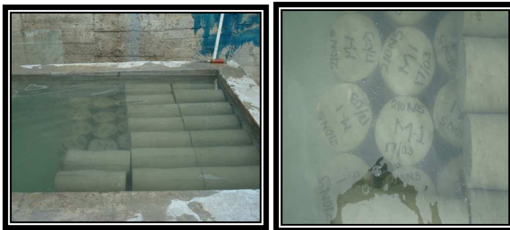
Imagen III.14 y III.15.- Curado de probetas
