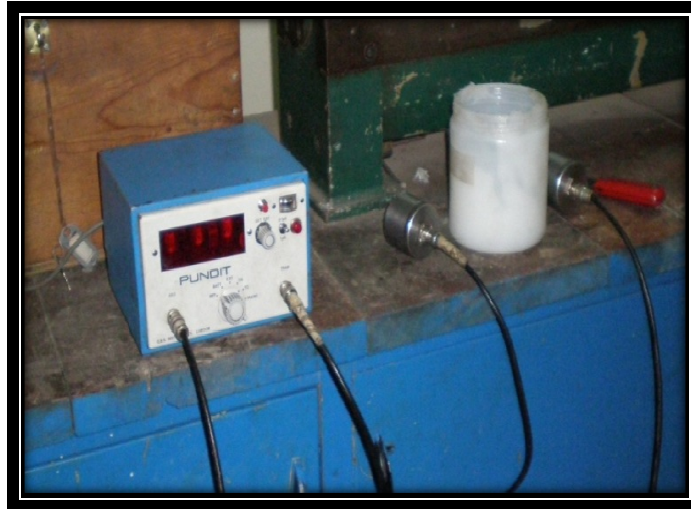
Imagen N°III.16 .- Ensayo de Ultrasonido
