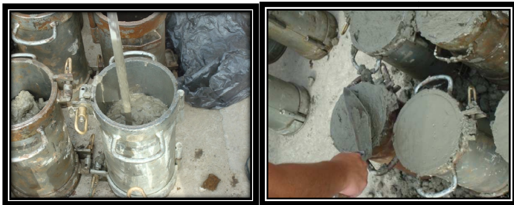
Imagen III.12 y III.13.- Elaboración de probetas
