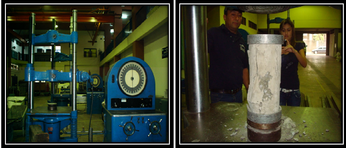
Imagen III.17 y III.18.- Ensayo a compresión
