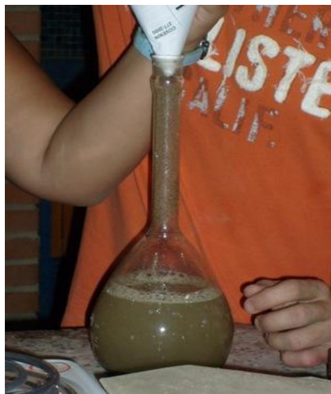
Figura III.20: Añadidura de la muestra saturada de superficie seca en el picnómetro con agua.
