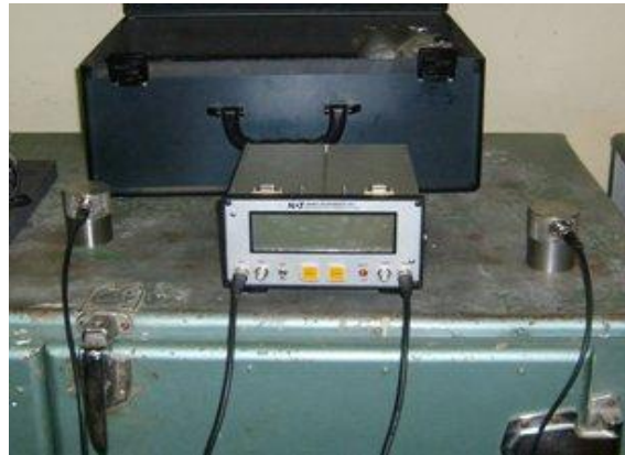
Figura III.32: Equipo para realización de ensayo de ultrasonido.
