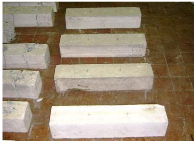
Figura III.46: Viguetas marcadas para perforación.
