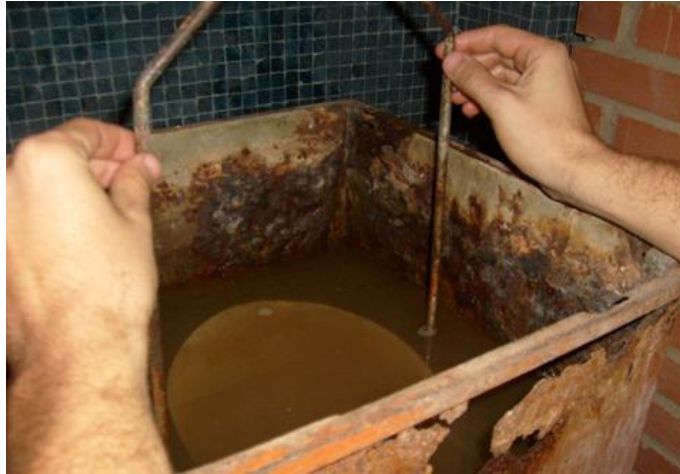
Figura III.15: Determinación de la masa en el agua de la muestra saturada de superficie seca.
