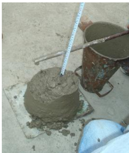
Figura III.26: Medición del asentamiento de la mezcla de concreto
