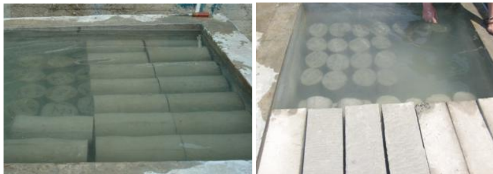
Figura III.31: Probetas en proceso de curado en la planta de “Rapid Concreto C.A.” ubicada en la Guaira, Estado Vargas.
