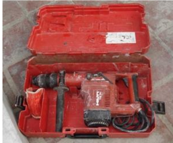
Figura III.47: Perforación con taladro roto-percutor Hilti para caracterización del epóxico.
