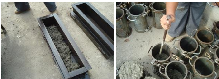
Figura III.28: Vaciado y compactación con 25 golpes de una barra de acero
