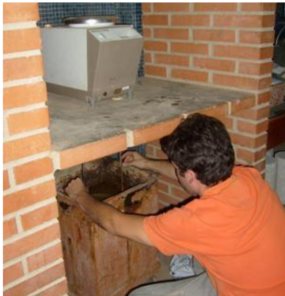
Figura III.13: Balanza con dispositivo inferior para suspender el recipiente.
