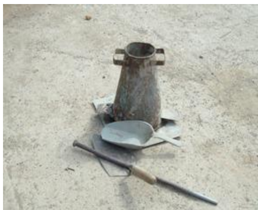
Figura III.24: Moldes y materiales para la realización del ensayo de medición de asentamiento Cono de Abrams, barra compactadora y cuchara arrocera.
