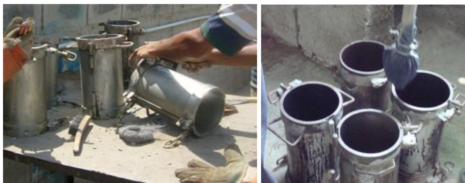
Figura III.27: Limpieza de moldes y colocación de gasoil en las mismas para probetas y viguetas.
