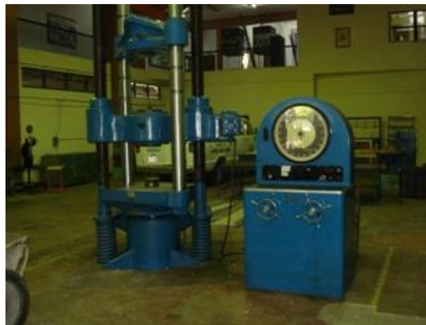
Figura III.36: Prensa Universal de 200 Ton marca Baldwin, ubicada en el “Instituto de Materiales y Modelos Estructurales” de la Universidad Central de Venezuela.
