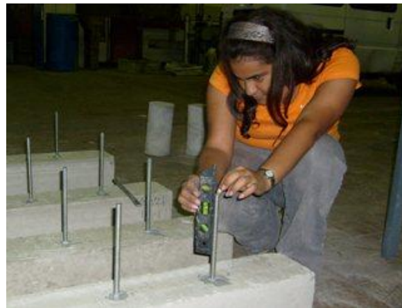
Figura III.54: Barras roscadas de acero SAE Grado 2 de \frac{1}{2} " de diámetro adheridas a viguetas para caracterización del epóxico
