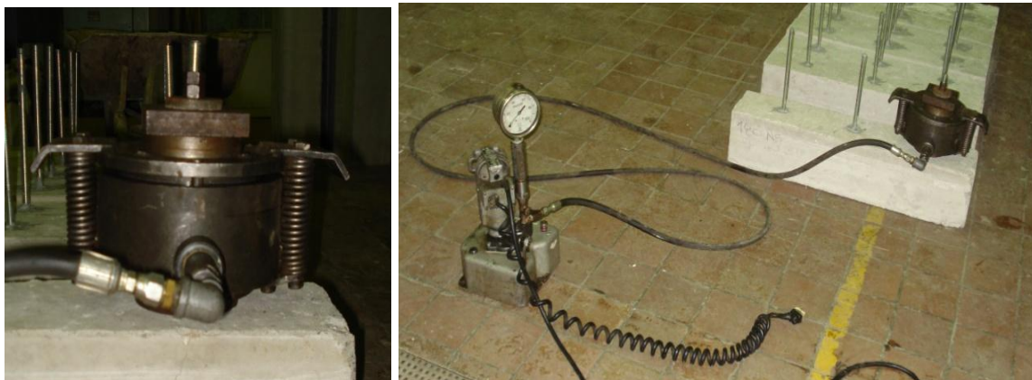
Figura III.63: Gato Hidráulico y Posición del gato en Sistema de Anclaje.
