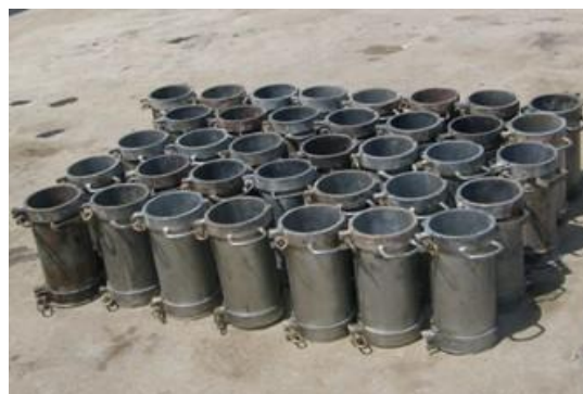
Figura III.22: Moldes metálicos cilíndricos de 15cm de diámetro y 30 cm de altura.
