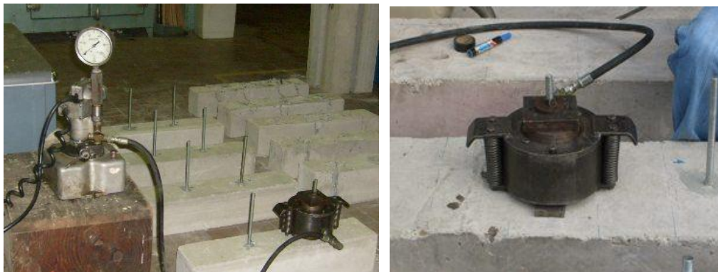
Figura III.55: Gato hidráulico, bomba hidráulica y manómetro de capacidad máxima 100 Kgf/cm 2 .
