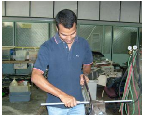
Figura III.51: Corte de barras roscadas a 25 cm con segueta y prensa mecánica.
