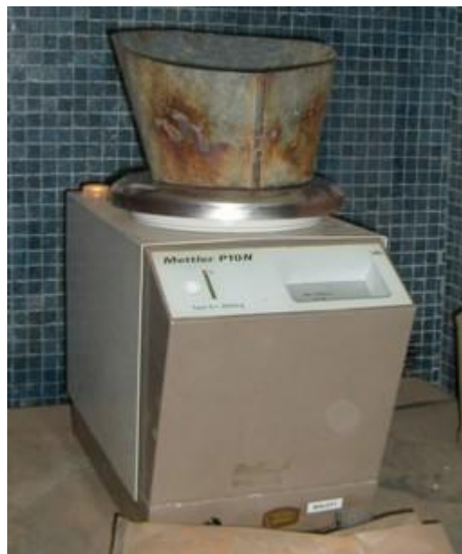
Figura III.12: Balanza Mettler P10N de carga máxima 3000 gr.
