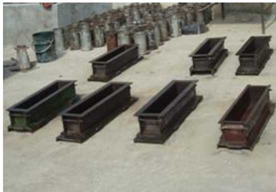
Figura III.23: Moldes para viguetas rectangulares de 80 cm de largo, 15 cm de ancho y 16 cm de alto.
