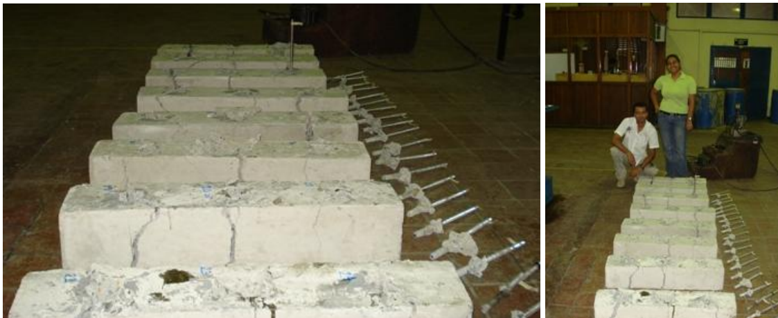
Figura III.65: Viguetas con los anclajes extraídos por Tracción.
