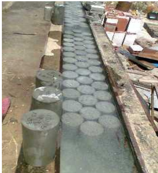
Figura III.6: Piscina dispuesta para el curado de cilindros y viguetas, ubicado en el IMME de la Universidad Central de Venezuela.
