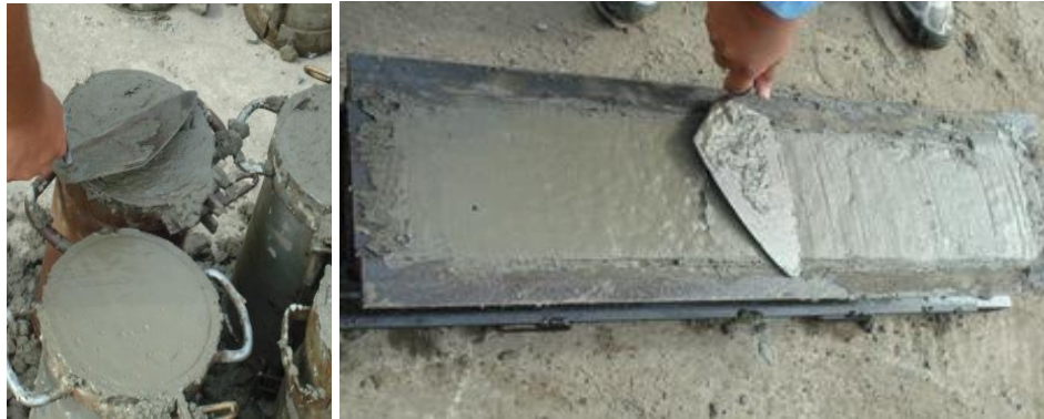
Figura III.29: Enrase de probetas de concreto y viguetas.
