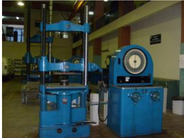
Figura III.41: Prensa Universal de ensayo marca Baldwin, ubicada en el “Instituto de Materiales y Modelos Estructurales” de la Universidad Central de Venezuela.
