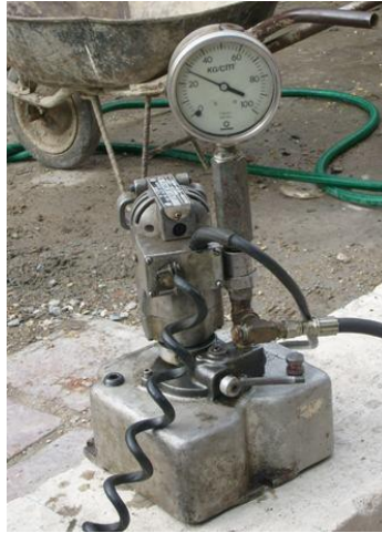
Figura III.44: Bomba hidráulica marca Power Unit y Manómetro.
