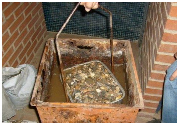
Figura III.14: Colocación de muestra saturada de superficie seca de gruesos en recipiente o cesta de alambre.
