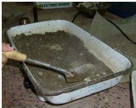
Figura III.16: Proceso de secado de superficie de la muestra en una hornilla a 110 \pm 5 °C
