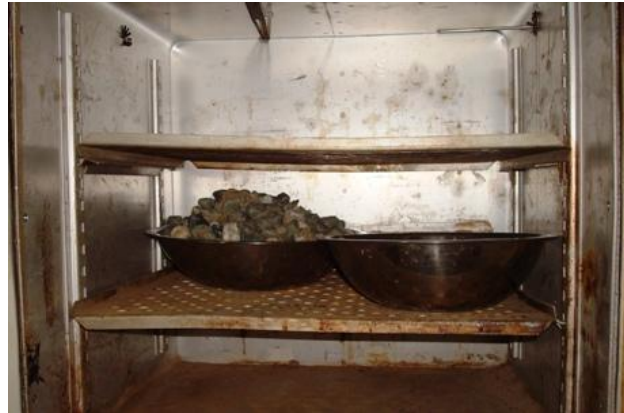
Figura III.11: Muestra húmedas de finos y gruesos en horno a 110 \pm 5 °C.
