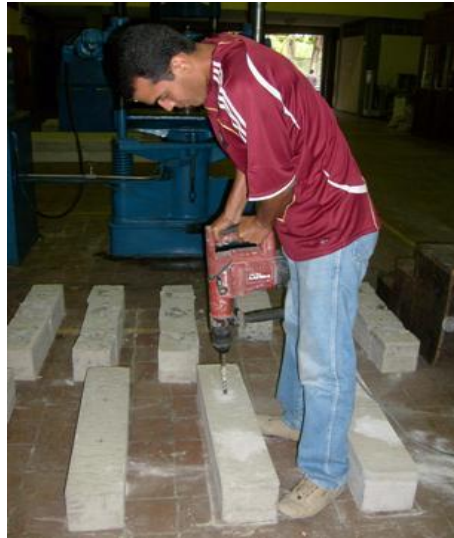
Figura III.49: Perforación con taladro roto-percutor Hilti para caracterización del epóxico.
