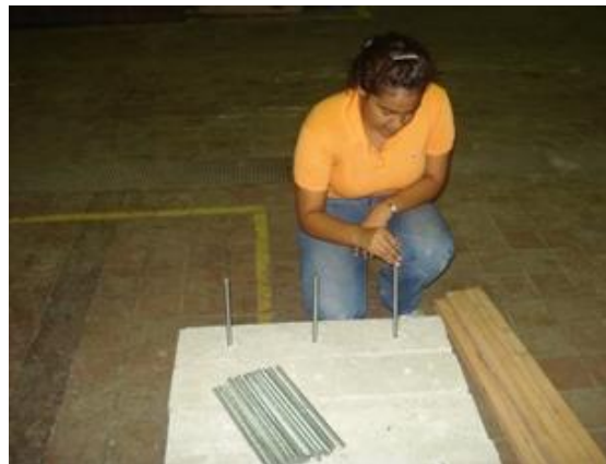
Figura III.60: Ajuste barras roscadas en las perforaciones realizadas.
