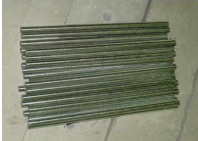
Figura III.40: Barras roscadas de acero SAE Grado 2 de \frac{1}{2} " de diámetro
