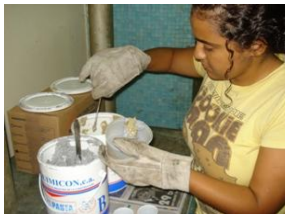
Figura III.52: Mezcla de la resina epóxica en pasta. (Componente con componente B).
