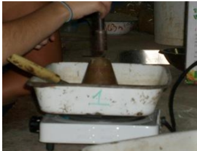
Figura III.18: Compactación de la muestra con un pequeño mazo.
