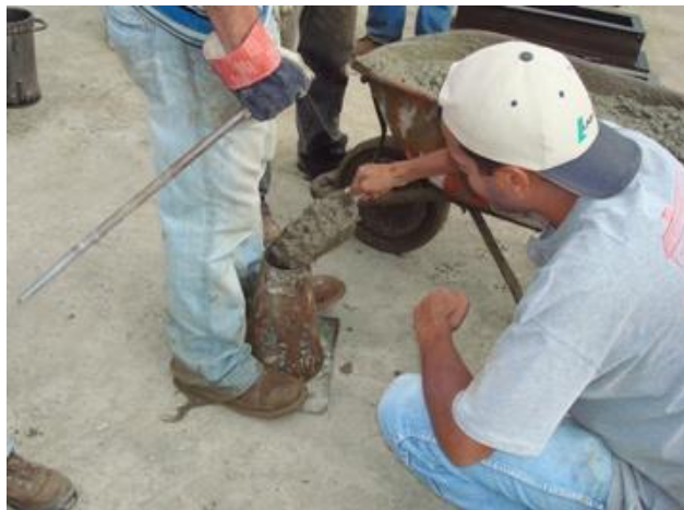
Figura III.25: Proceso de vaciado del cono de Abrams.
