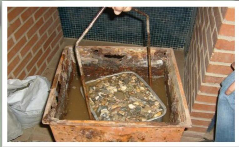
**Colocación del agregado saturado con superficie seca en recipiente o cesta de alambre**
