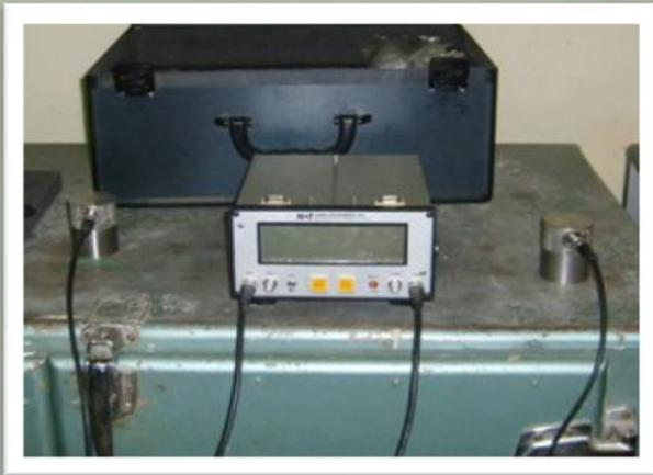
**Equipo para realización de ensayo de ultrasonido.**
