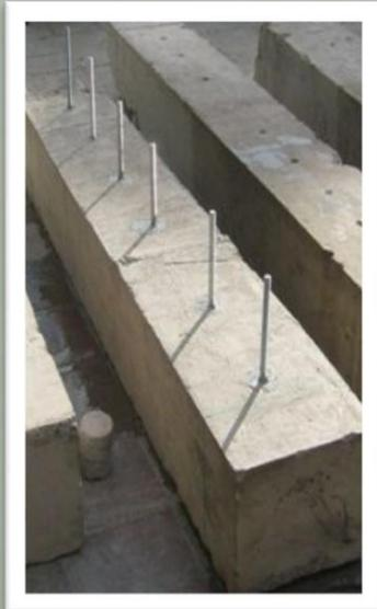
Secado de la resina en 24 horas (Este procedimiento también se realizó en la viga expuesta a flexión y dejada al aire libre)
