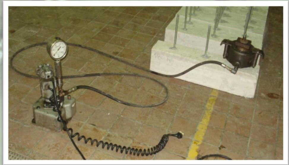
Extracción de las barras roscadas por medio de tracción después de 24 hora luego de haber colocado el epóxico
