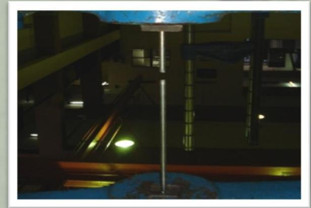
Medición de deformación de las barras
