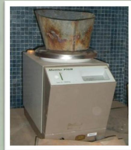
**Determinación de masa de los agregados después del secado.**
