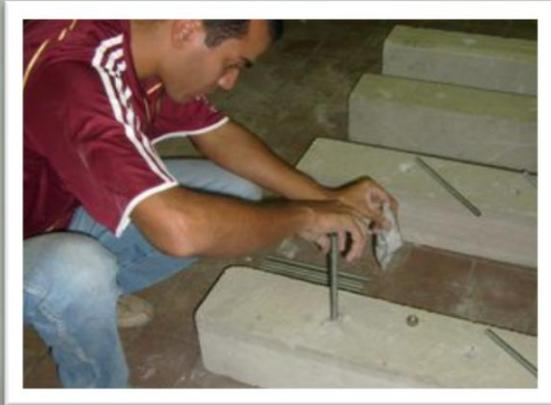
Colocación de epóxico en orificios de las viguetas. Se dejó secar durante 24 horas
