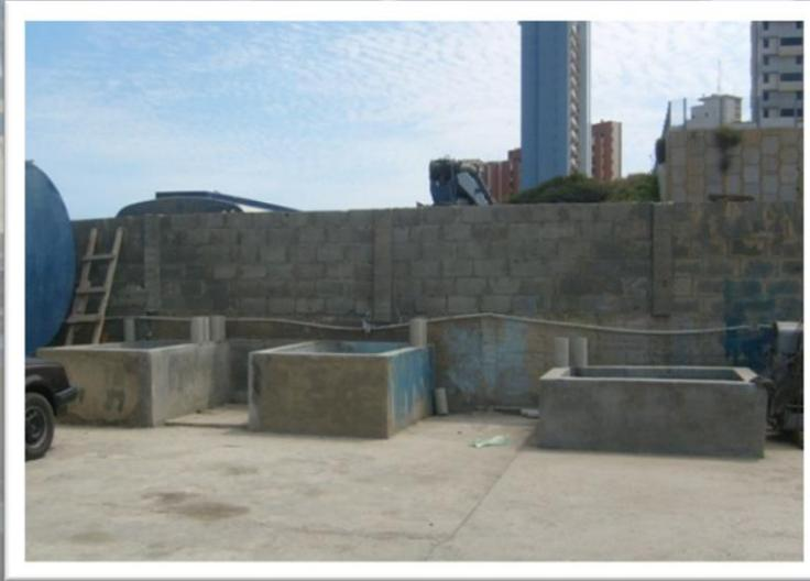
**Piscinas dispuestas para el curado de cilindros y viguetas.**
