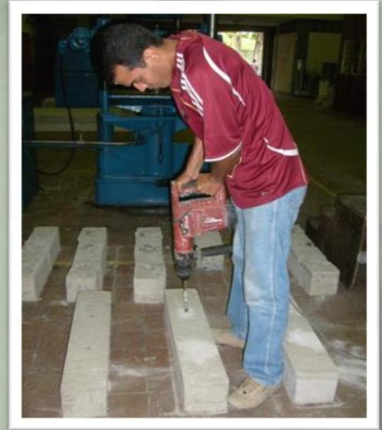
Perforación con taladro roto-percusor Hilti para caracterización del epóxico.
