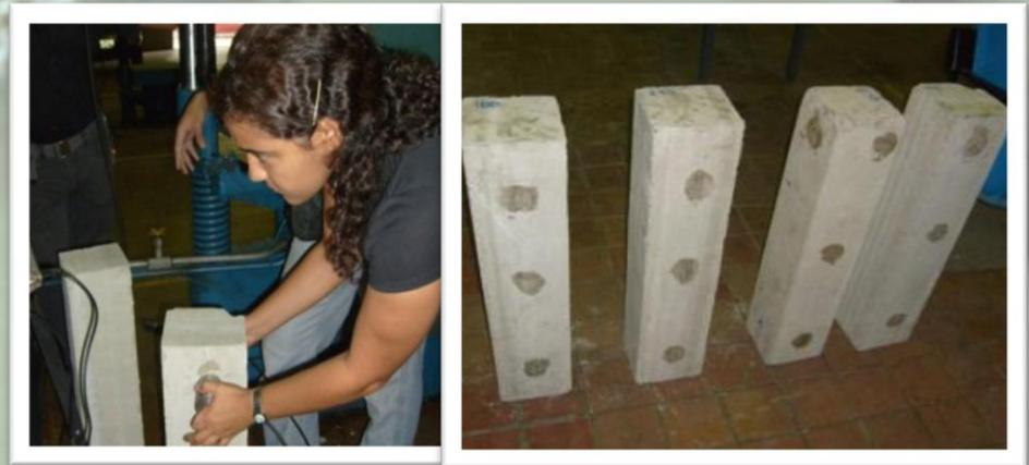
**Realización del ensayo de ultrasonido con monitor y palpadores**
