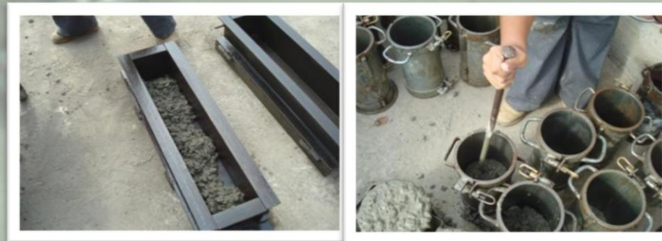
3) Vaciado y compactación del concreto en los moldes
