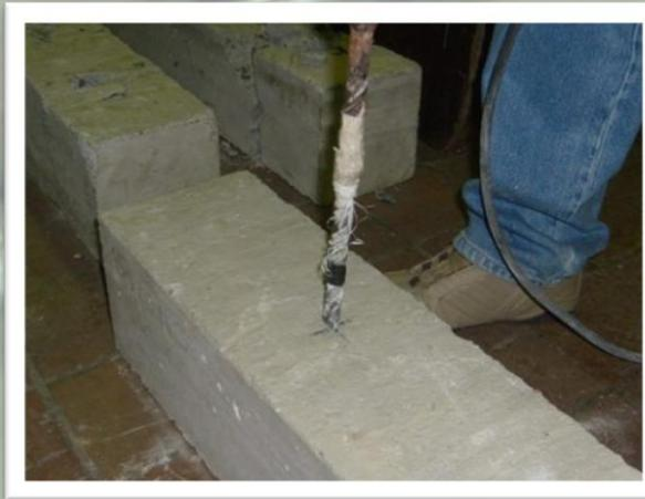
Se marcó la broca de 5/8" con una altura de 4 cm para identificar la profundidad de la perforación
