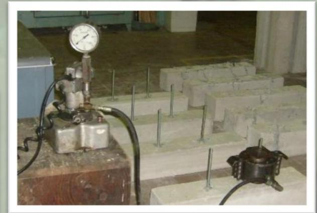
Ensayo de tracción para caracterización del epóxico
