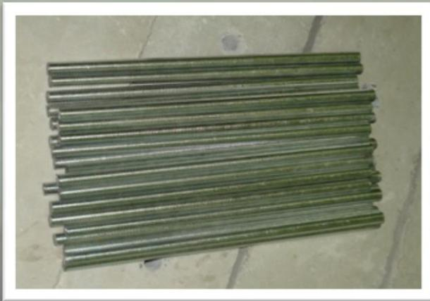
Barras roscadas de acero SAE Grado 2 de 1/2" de diámetro y una longitud de 70 cm
