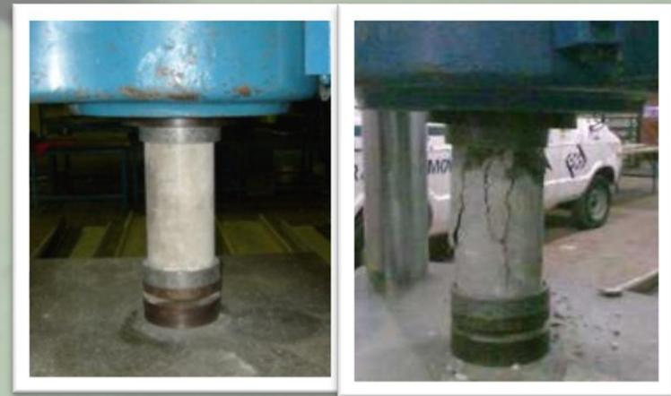
Ensayo a compresión en prensa universal
