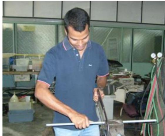
**Corte de barras roscadas a 25 cm con segueta y prensa mecánica**
