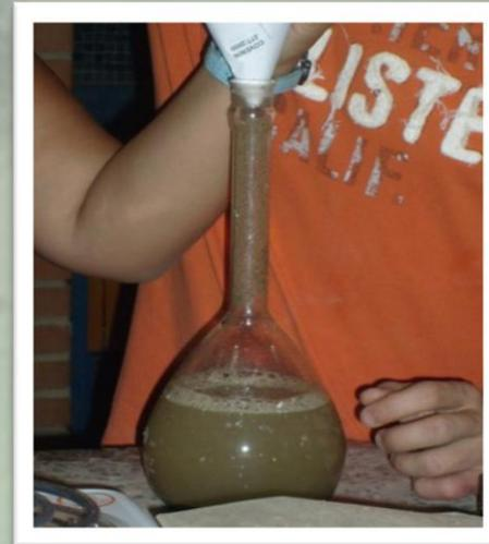
**Añadidura de la muestra saturada de superficie seca en el picnómetro con agua.**
