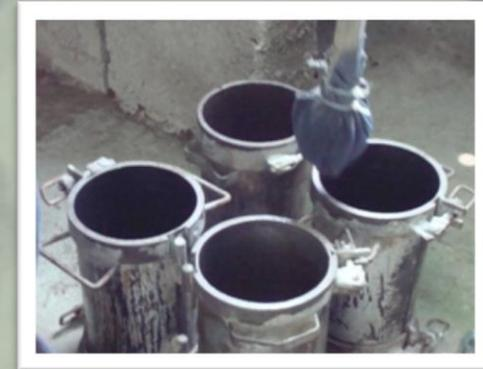
2) Colocación de gasoil con estopa
