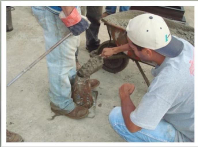
**Proceso de vaciado del cono de Abrams.**
