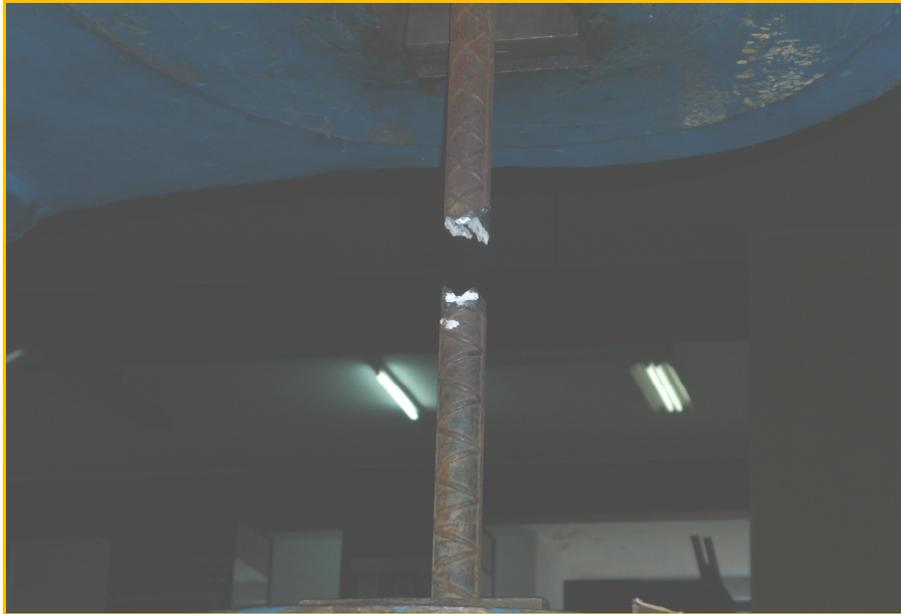
ANEXO 13. Muestra soldada a tope que falló por soldadura.
