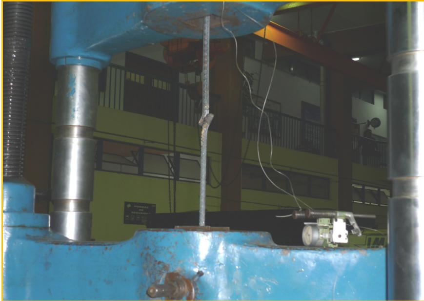
ANEXO 11. Muestra soldada a solape que falló por soldadura.
