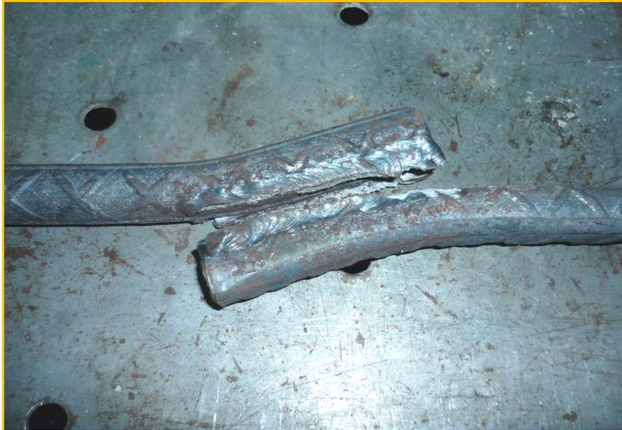
ANEXO 15. Muestra soldada a solape simple que falló por soldadura.
