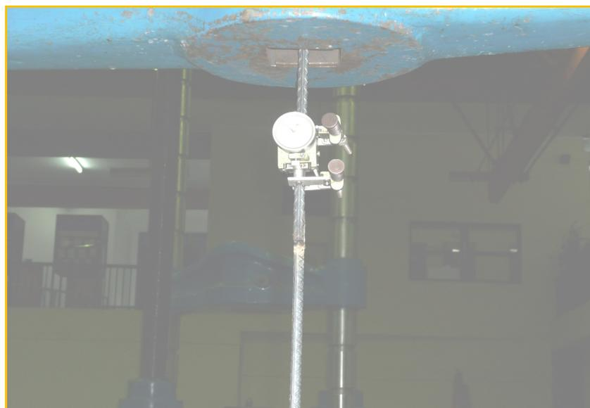
ANEXO 10. Muestra soldada colocada en máquina para ensayar.
