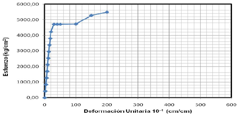
**GRÁFICA 4.14. Esfuerzo-Deformación Unitaria Muestra M4 de Junta Soldada con Solape Simple Barra de Refuerzo 3/8"**
