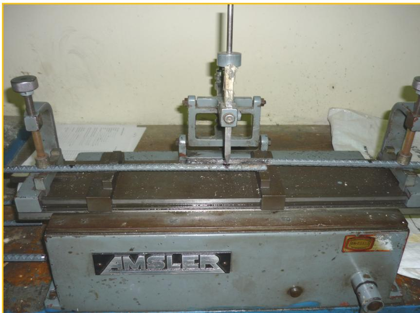
ANEXO 8. Marcación de 20cm en barras soldadas a solape para verificar alargamiento luego del ensayo.
