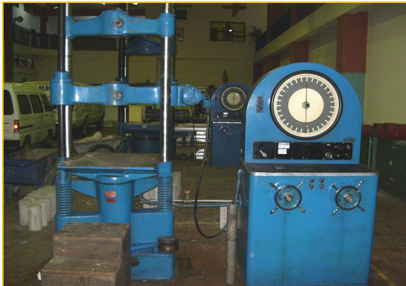
ANEXO 4. Barra patrón colocada en maquina de ensayo.
