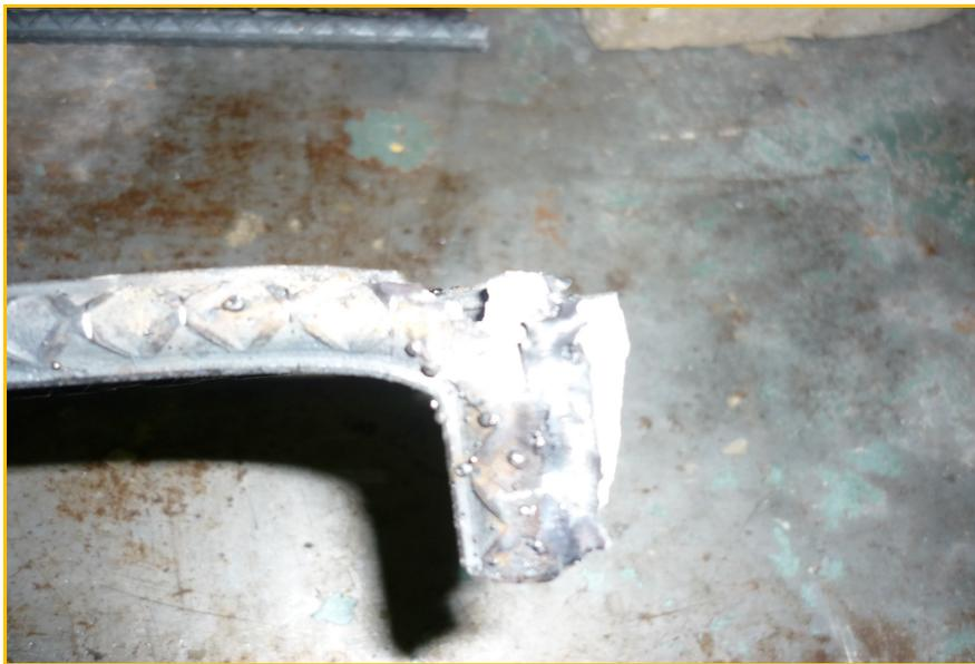
ANEXO 12. Muestra que falló por el metal observando desprendimiento de la otra barra en esta.
