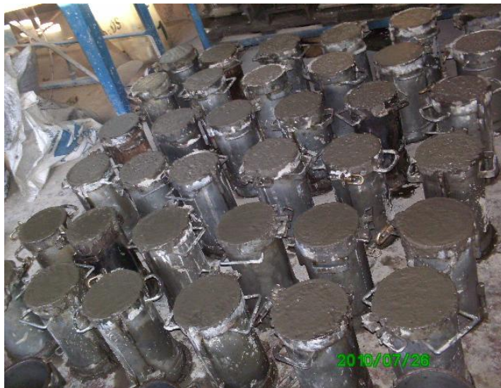
Anexo 13. Probetas encofradas
