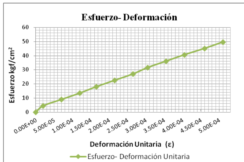
Gráfico IV.1.5.8-2 Curva Esfuerzo – Deformación. Mezcla con 45% CV
