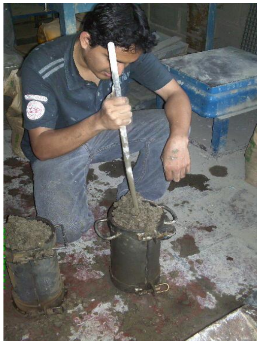
Anexo 12. Llenado y compactado en moldes cilíndricos
