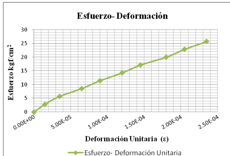
Gráfico IV.1.5.4-3 Curva Esfuerzo – Deformación. Mezcla con 45% CV
