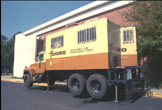
Camión Fugro Típico de CPT en tierra Lunne, 1997
