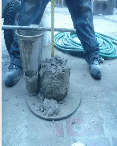
Fig. 3. 40. Medición del asentamiento
