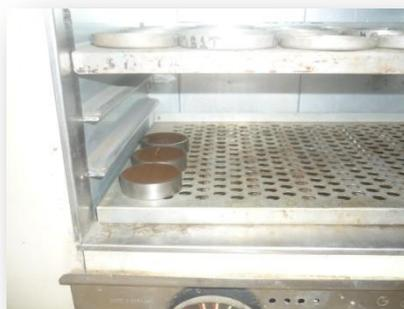
Fig. 3. 24. Colocación de los moldes de acero inoxidable en la Mufla de Secado a 110°C IMME UCV. Caracas, Distrito Capital
