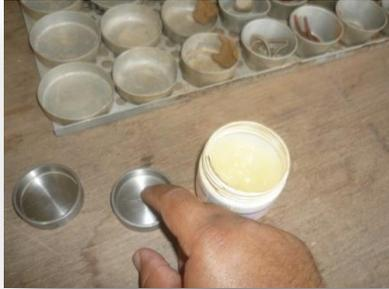
Fig. 3. 17. Preparación del molde de acero inoxidable
