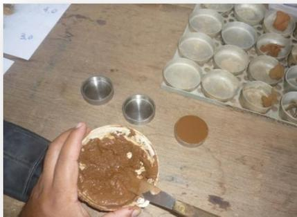
Fig. 3. 19. Preparación de la muestra en moldes de acero inoxidable
