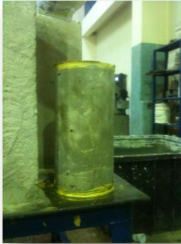
Fig. 3. 33. Preparación de los cilindros para ser ensayados
