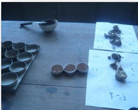
Fig. 3. 21. Extracción de los vacíos de las muestras contenidas en los moldes de acero inoxidable IMME UCV. Caracas, distrito capital
