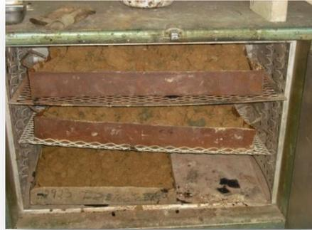
Fig. 3. 8. Bandeja con lodo, previo a colocación en horno de secado IMME UCV. Caracas, Distrito Capital
