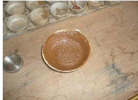
Fig. 3. 15. Muestra saturada
