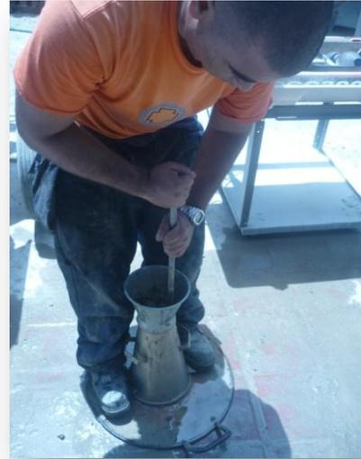
Fig. 3. 38. Compactación de la muestra del cono
