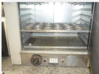
Fig. 3. 23. Colocación de los moldes de acero inoxidable en la Mufla de Secado a 110°C IMME UCV. Caracas, Distrito Capital
