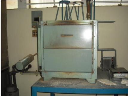
Fig. 3. 11. Horno de incineración a 650°C
