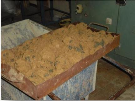
Fig. 3. 7. Bandeja con lodo, previo a colocación en horno de secado IMME UCV. Caracas, Distrito Capital
