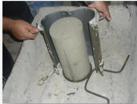
Fig. 3. 32. Desencofrado de los cilindros
