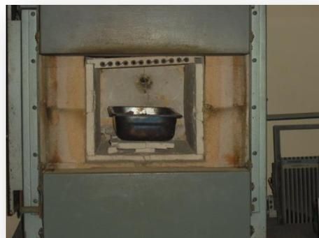
Fig. 3. 10. Bandeja con lodo, colocada en horno de incineración IMME UCV. Caracas, Distrito Capital
