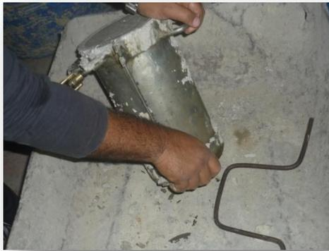
Fig. 3. 31. Desencofrado de los cilindros
