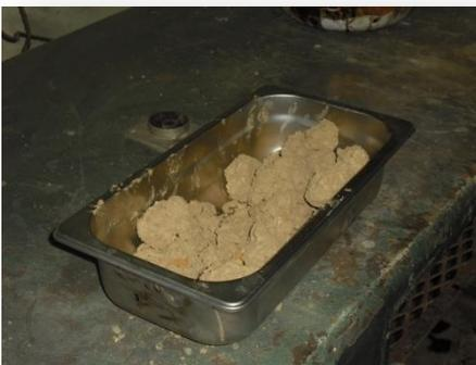
Fig. 3. 9. Bandeja con lodo, previo a colocación en horno de incineración IMME UCV. Caracas, Distrito Capital
