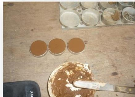
Fig. 3. 20. Preparación de la muestra en moldes de acero inoxidable
