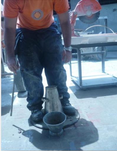
Fig. 3. 37. Preparación del cono de Abrams
