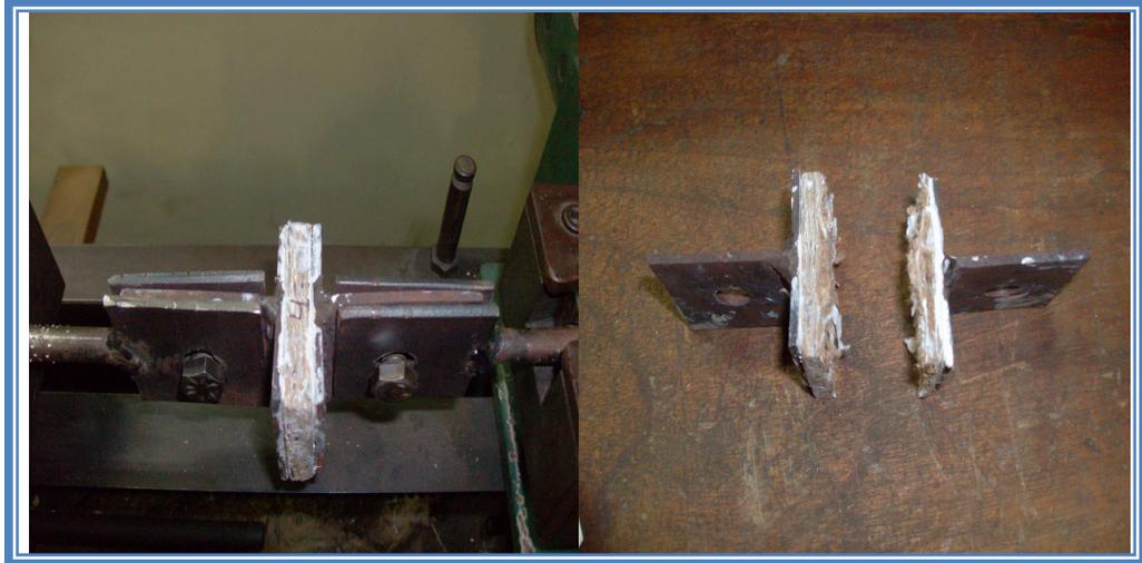
**Figura 42:** Rotura de las probetas del ensayo de tracción perpendicular a la superficie del tablero
