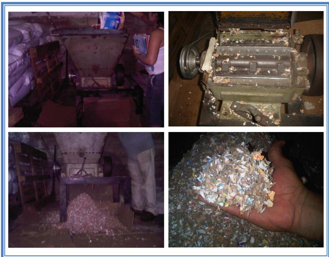
**Figura 23:** Molino, cuchillas, Tetra brick® molido
