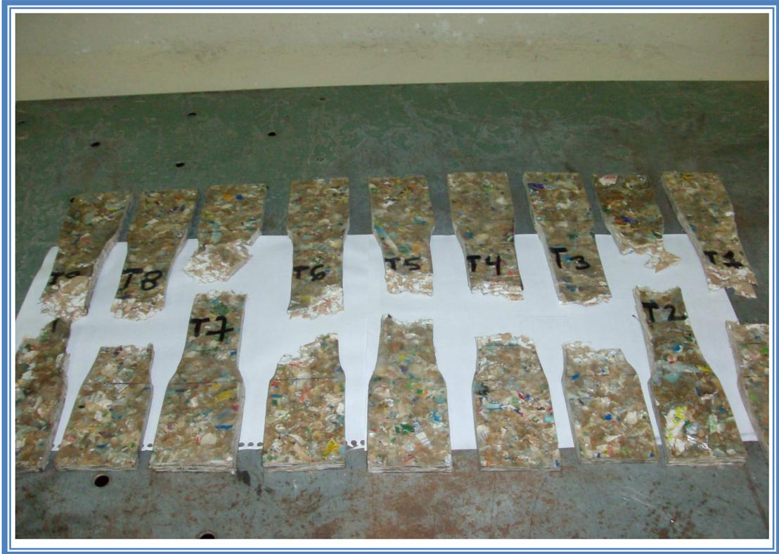
**Figura 43:** Rotura de las probetas en ensayo de tracción paralela a la superficie del tablero
