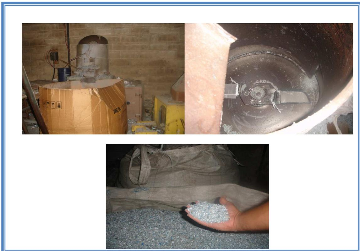
**Figura 25:** Proceso de obtención del PEBD granulado
