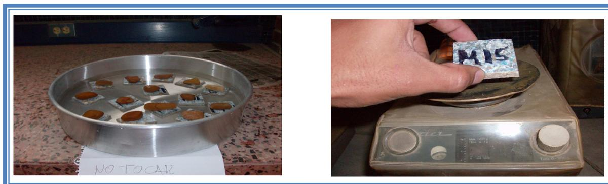
**Figura 35:** Probetas inmersas en agua a 2 y 24 horas
