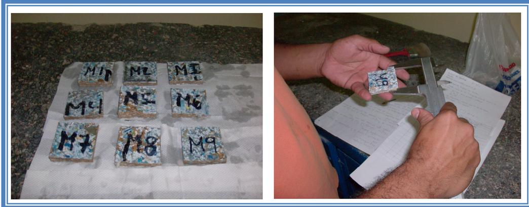
**Figura 34:** Probetas para ensayo de densidad
