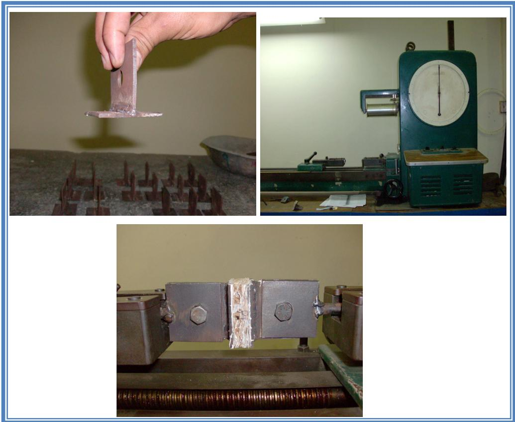
**Figura 37:** Ensayo tracción perpendicular a la superficie del tablero.
