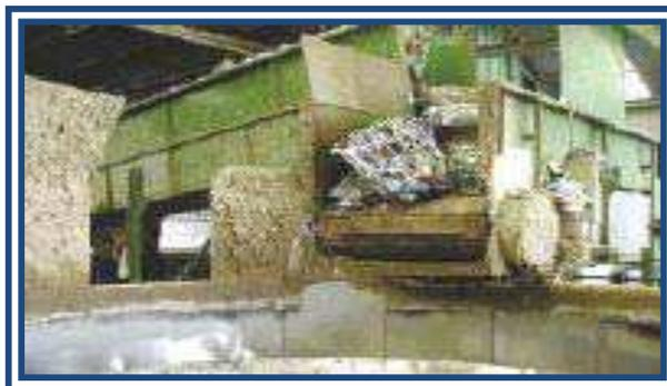
**Figura 10:** Colocación de los envases en un hidropulper.
