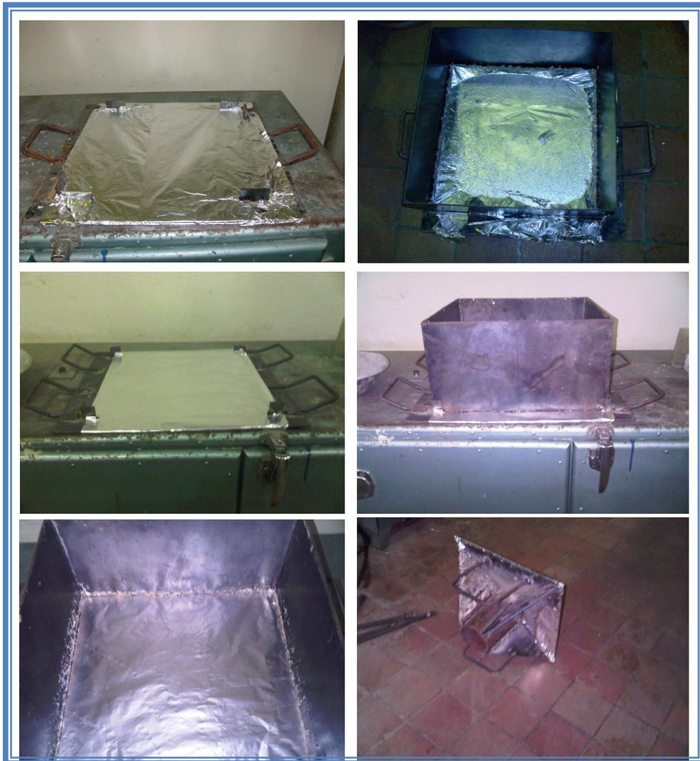
**Figura 27:** Preparación de Placa, encofrado
