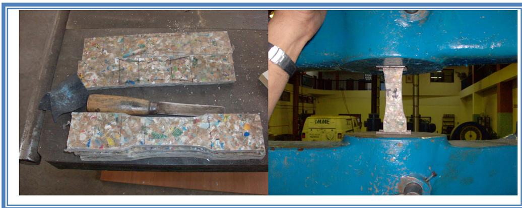
**Figura 39:** Ensayo tracción paralela a la superficie del tablero
