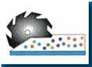
**CORTE A MEDIDA:** aquí se realiza el corte para que el panel obtenga su medida definitiva la cual fue especificada anteriormente. El corte de estos paneles se debe realizar con elementos que posean en sus partes cortantes vidia.
