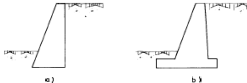
Figura 3. Estructuras de Muros de Hormigón en Masa
