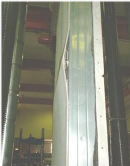
Foto No. 13: Ensayo a Compresión, falla del recubrimiento interno
