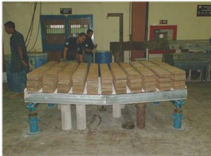
Foto No. 6: Ensayo a Flexión, cara externa hacia arriba, falla del panel (I)
