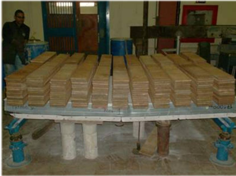
Foto No. 9: Ensayo a Flexión, cara externa hacia abajo, falla del panel (I)
