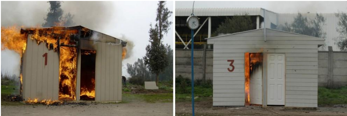
Ilustración 17: Ensayo contra el fuego en viviendas construidas por diferentes materiales, realizado por la empresa Volcán. Fuente: Plataforma Arquitectura (2011)
