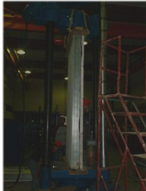
Foto No. 12: Ensayo a Compresión (II)
