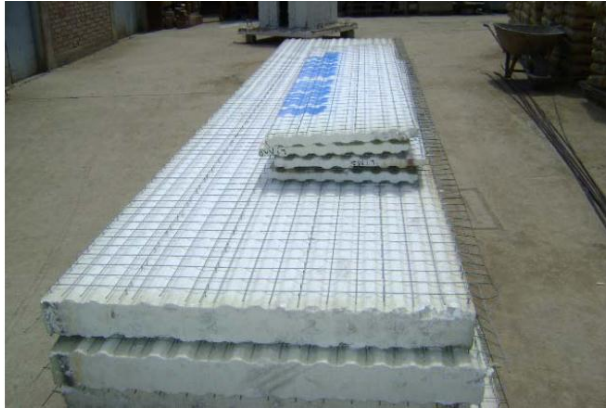
Ilustración 25: Paneles a ensayar como losas de techo del sistema M2. Fuente: Laboratorio de Estructuras de la Pontificia Universidad Católica del Perú
