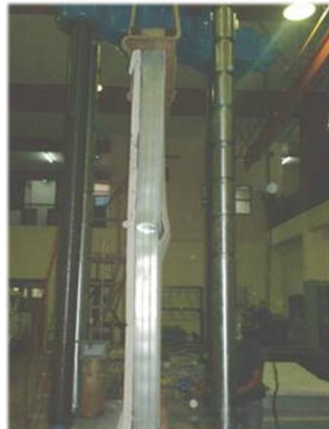
Foto No. 14: Ensayo a Compresión, falla del recubrimiento interno y perfil
