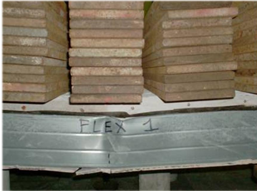
Foto No. 7: Ensayo a Flexión, cara externa hacia arriba, falla del panel (II)
