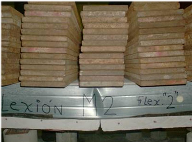
Foto No. 10: Ensayo a Flexión, cara externa hacia abajo, falla del panel (II)
