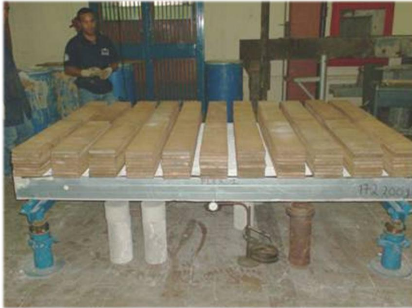
Foto No. 5: Ensayo a Flexión, cara externa hacia arriba
