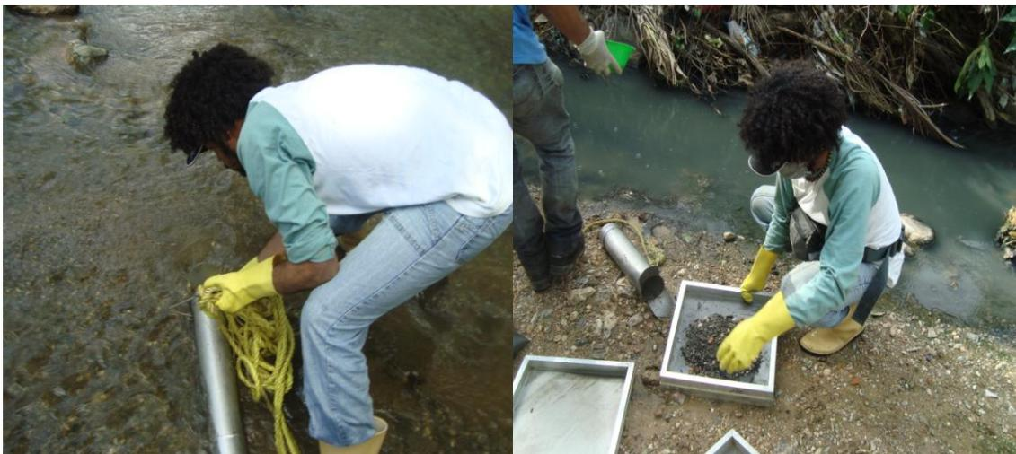
Cilindro metálico (muestreador) (Río Guare)
