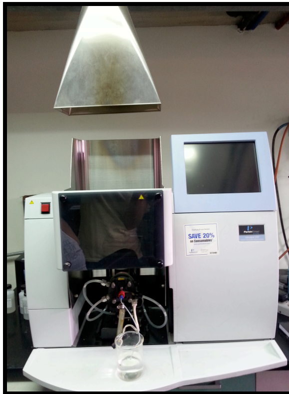
Figura A.2. Espectrómetro de Absorción Atómica (AAS) marca PERKIN ELMER, modelo AAnalyst 200
