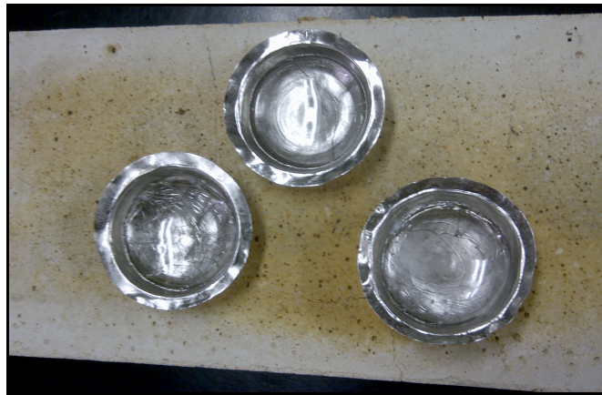
Figura 6. Perlas generadas por la fusión alcalina de las muestras no-magnéticas.
