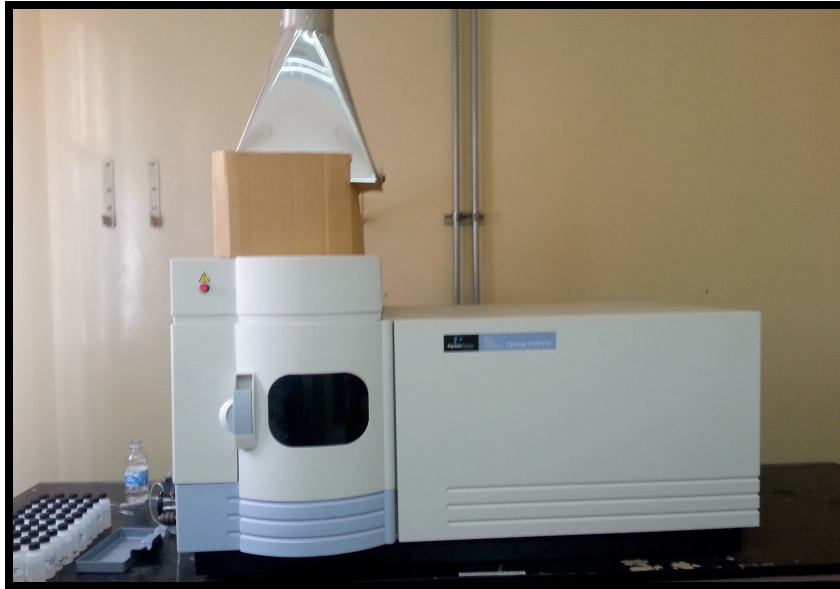
Figura A.3. Espectrómetro de Emisión Óptica con Plasma Inductivamente Acoplado (ICP-OES) marca PERKIN ELMER, modelo OPTIMA 2100DV
