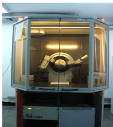
Fig. 5 Difractómetro de rayos X, marca Siemens, modelo AXs Broker D8 advance.
