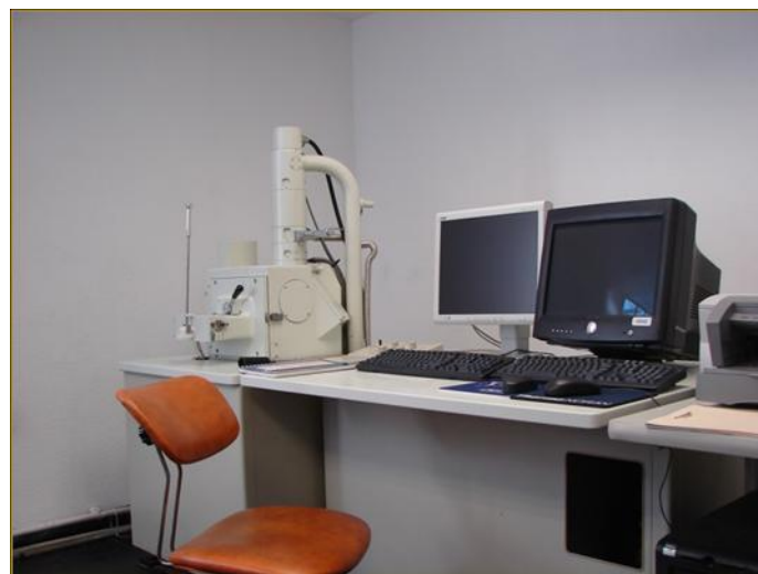
Fig. 4 Microscopio electrónico de barrido, marca JEOL, modelo JSM-5910LV.
