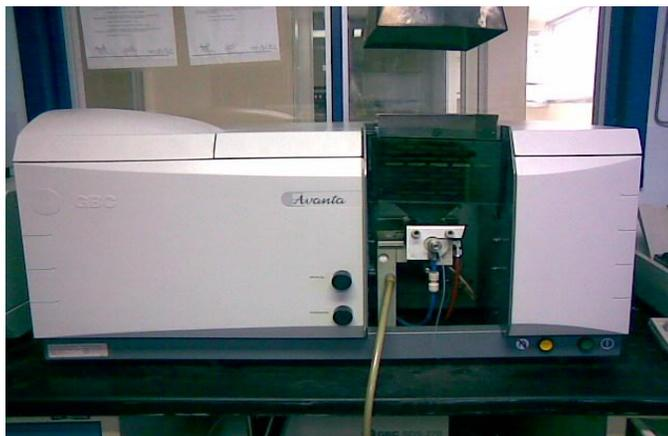
Figura 13. Espectrofotómetro de absorción atómica de llamas.
