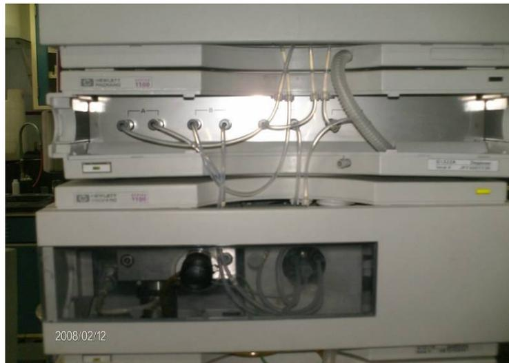
Figura 7. Desgasificador HP serie 1100
