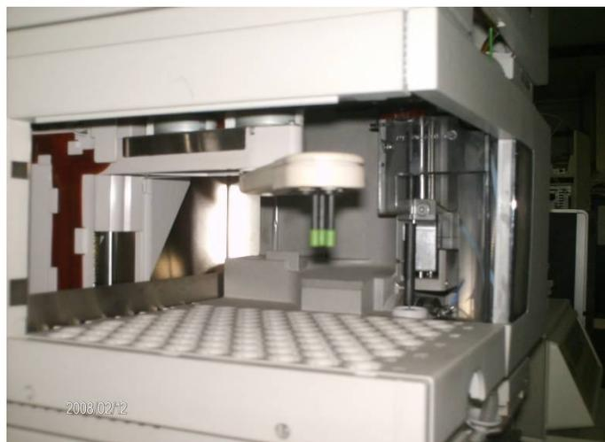
Figura 9. Automuestreador HP serie 1100 con contenedor de 100 portaviales
