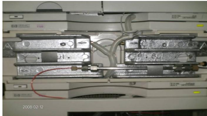
Figura 10. Sección de columna cromatógrafo HP serie 1100
