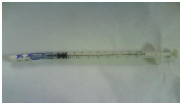
Figura 17. Cartucho de SPE con jeringa para pruebas preliminares de adsorción de la alúmina
