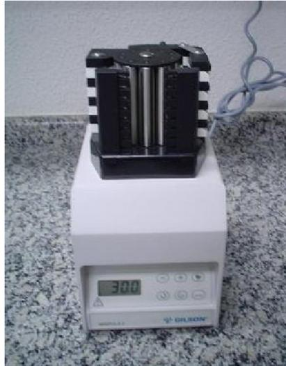
Figura 18. Bomba peristáltica marca Gilson modelo miniplus 3 utilizada para la SPE
