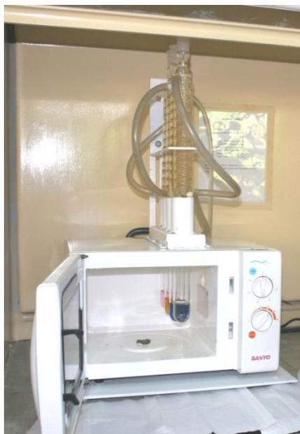
Figura 6: Horno de microondas modificado.
