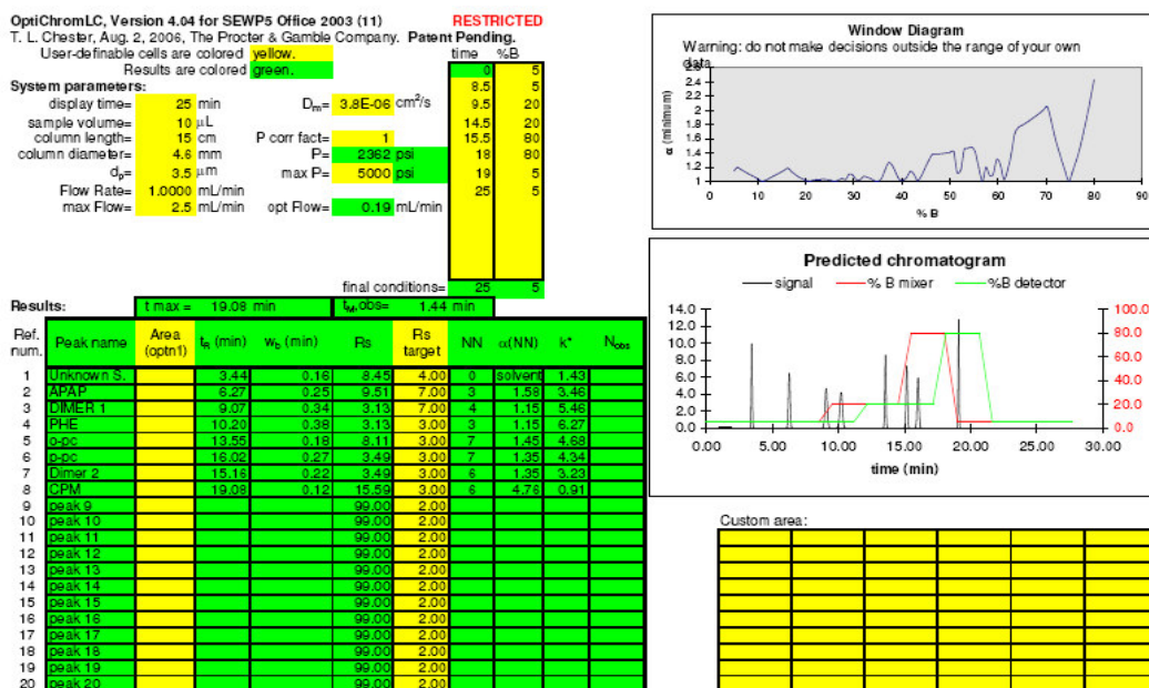
Figura 34. Predicción Cromatográfica para Acetaminofén, Fenilefrina y sus productos de degradación utilizando una fase móvil compuesta por metanol/tetraborato de sodio (10mM) a pH 9,38 y un flujo de fase móvil de 1 mLmin -1
