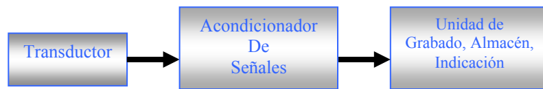
Figura N° 5.1 Sistema de medición básico.
