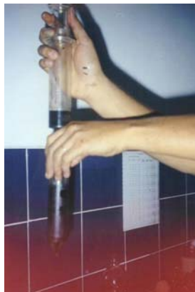
Figura 8: Eliminación del agua para el corte en centrífuga
