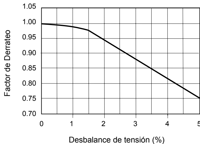
Figura A.2.4 Curva de derrateo de un motor de inducción [47]
