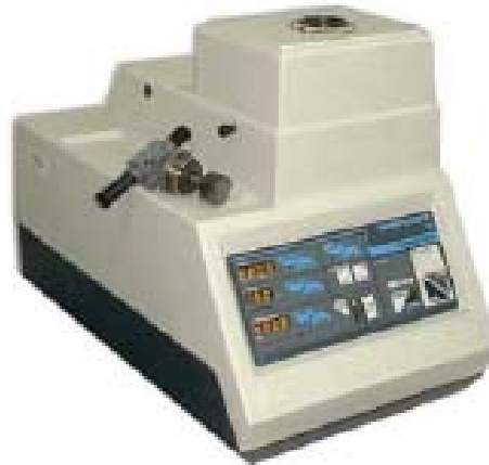
Figura III-8.- Equipo de Montaje, marca Buehler, modelo Simplimet II.
