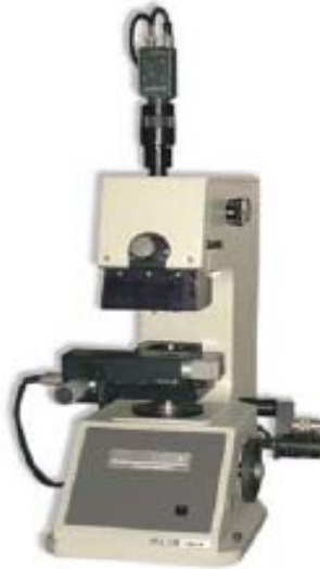
Figura III-14.- Microdurómetro marca Leco, modelo M400H.
