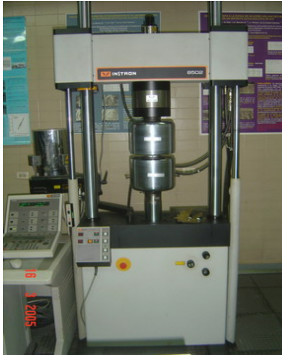
Figura III-19.- Máquina Universal de Ensayos Mecánicos, marca Instron, modelo 8502.
