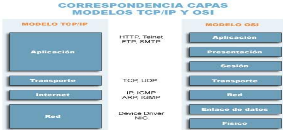
Figura 5. Capas TCP/IP, protocolos TCP/IP y correspondencia con las capas OSI
