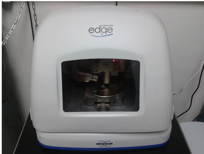
Figura 3.2: Microscopio AFM modelo Dimension EDGE, de la compañía Bruker, utilizado.
