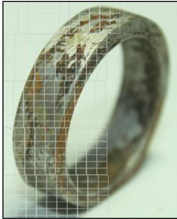
Figura 10. Ejemplificación del empleo de la cuadrícula sobre las imágenes superficiales de las muestras.
