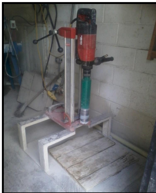
Anexo 4. Perforadora tubular para la obtención de probetas cilíndricas.
