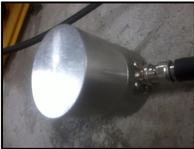
Anexo 26. Emisor y transmisor, ensayo de ultrasonido.
