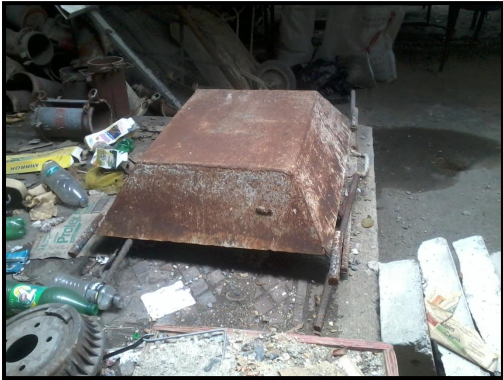
Anexo 18. Antigua formaleta de vigueta.
