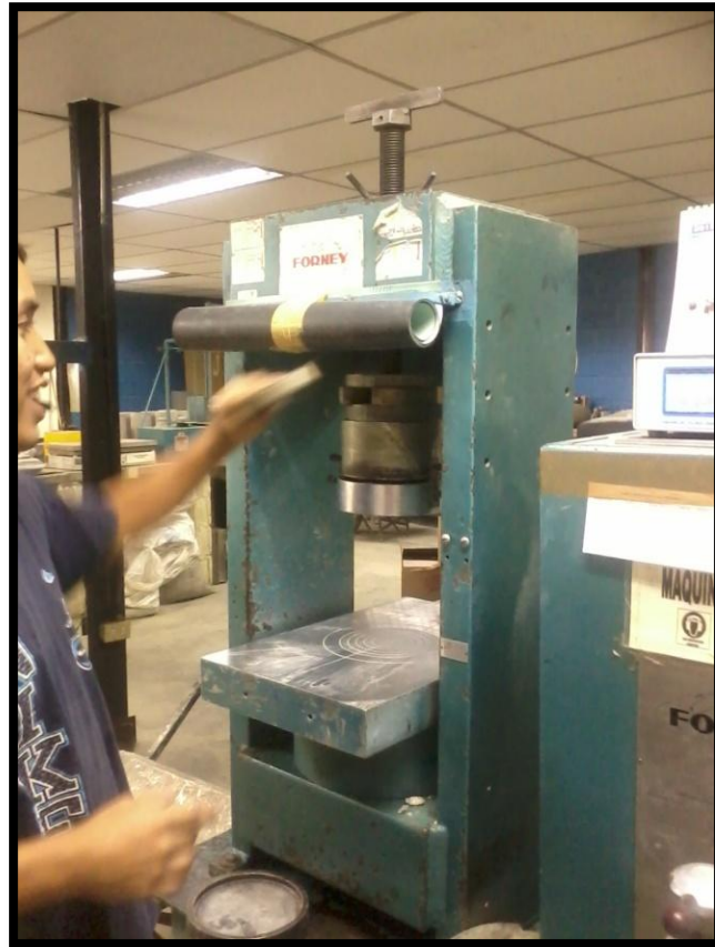
Anexo 5. Prensa para ensayos a compresión de los núcleos.
