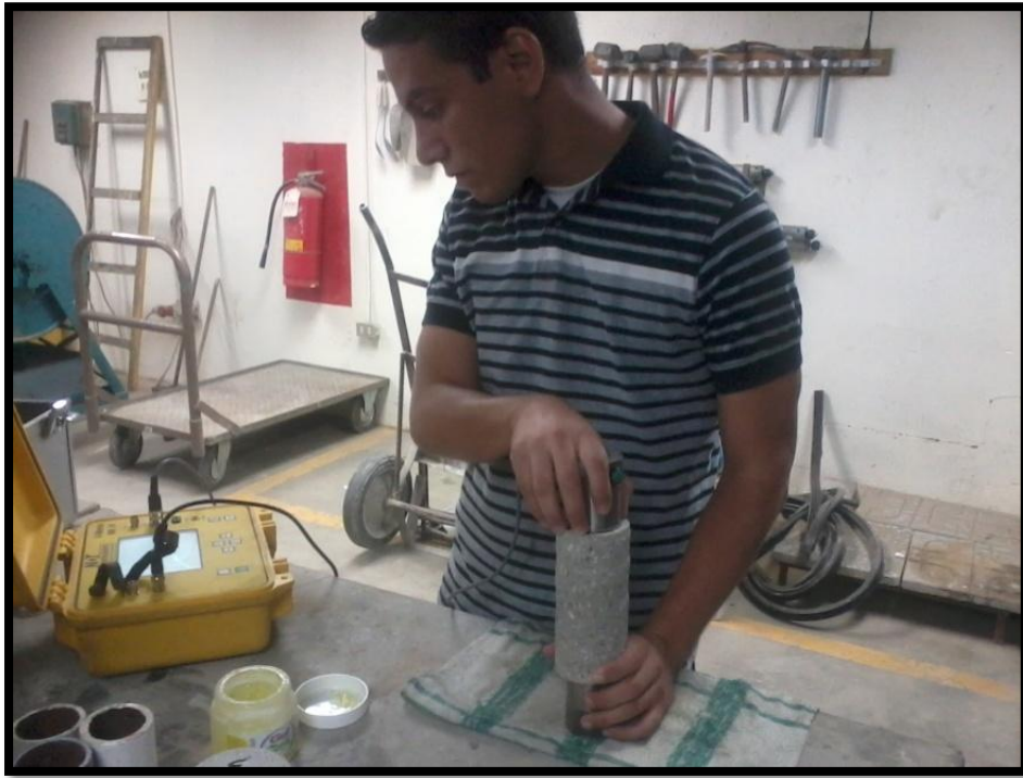
Anexo 12. Ensayo de ultrasonido en los núcleos.
