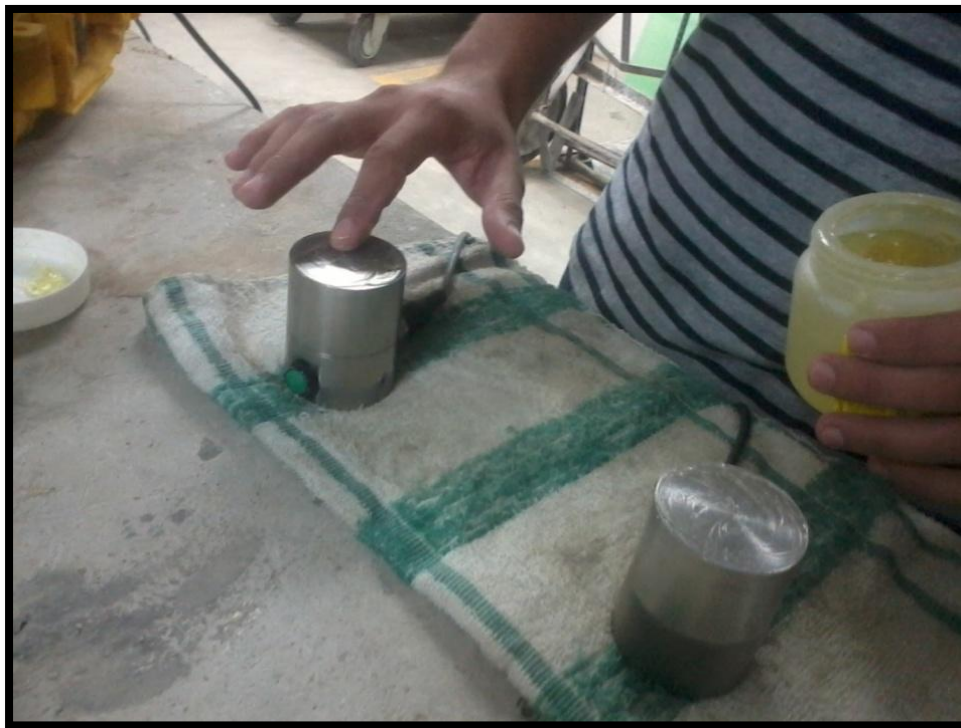
Anexo 10. Ensayo de ultrasonido sobre la vigueta.
