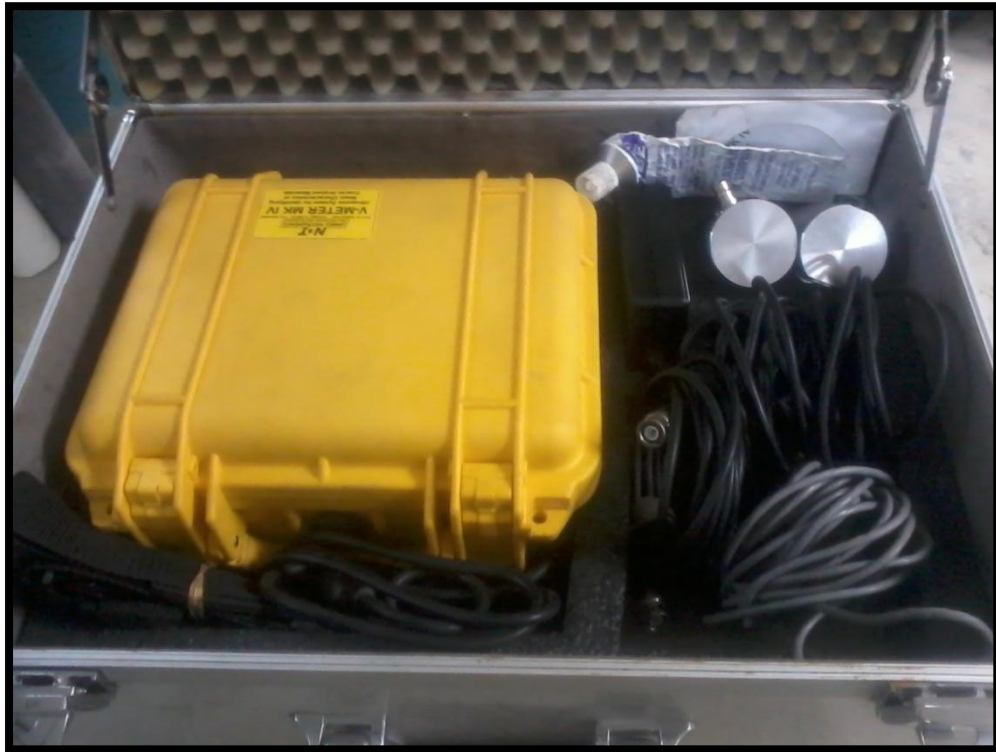
Anexo 24. Instrumento utilizado para el ensayo de ultrasonido.
