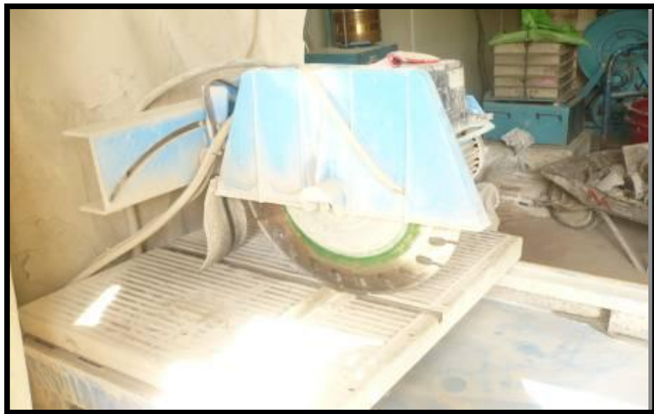
Anexo 6. Sierra para cortar probetas cilíndricas hasta el tamaño adecuado para ensayos de resistencia a compresión.
