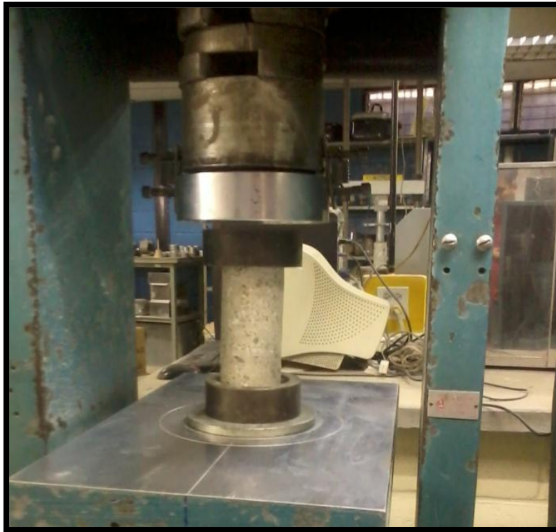
Anexo 13. Ensayo a compresión.
