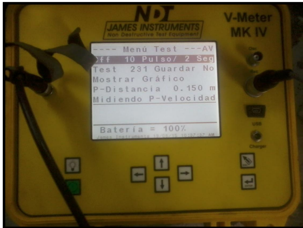
Anexo 25. Instrumento utilizado para el ensayo de ultrasonido.
