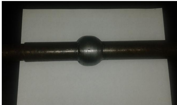
Figura 67. Fotografía del cilindro interno con protuberancia elaborado en el taller mecánico del IMME.
