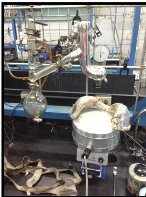
Figura 20. Sistema de deshidratación por destilación.
