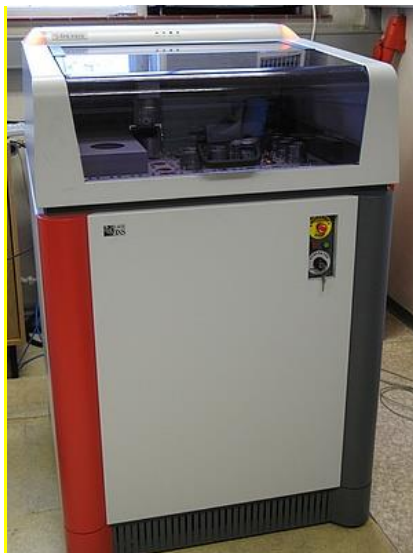
Figura 22. Equipo marca Bruker S4 para la determinación de V, Ni y S.
