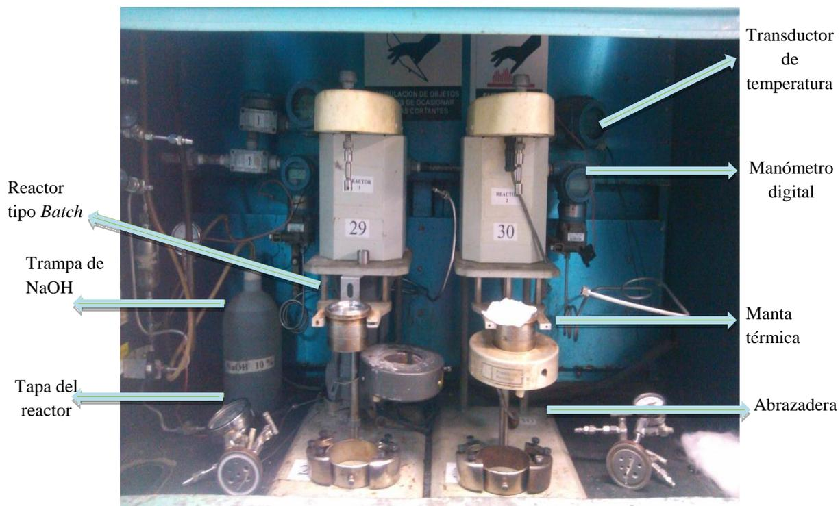
**Figura 16.** Equipo autoclave para los ensayos de solubilidad de  $H_2S$ .
