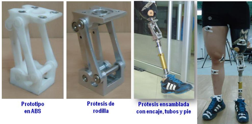
Figura 5. Prototipos de la prótesis de rodilla y montaje en paciente con amputación transfemoral unilateral.
