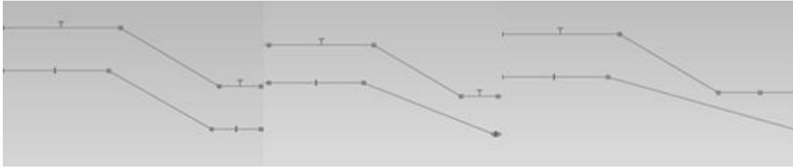
Figura 4: Variación del perfil de la reducción en el tiempo por efectos de la erosión
