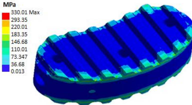
Figura 3- Concentración de tensiones en la caja intersomática TLIF INABIO, del modelo sin instrumentación posterior ante compresión axial con flexión anterior
