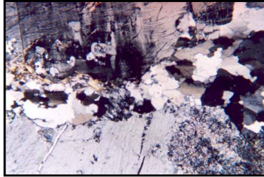
RM-602-r 12. (N: X). Meta-trondhjemitas. Granos de plagioclasa sausrinizados y textura pertítica, en contacto con agregados granulares de cuarzo. Boredes albiticos entre plagioclasa y feldespato potásico.
