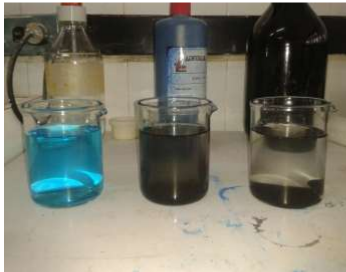
Figura 5. Comparación de la adsorción de azul de metileno. Izquierda, Blanco; centro, Merck; derecha, Carbón sintetizado.
