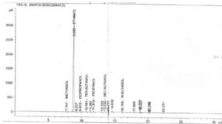
Figura 1. Cromatograma del destilado obtenido para la relación 1:0,5
