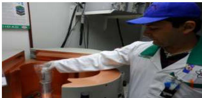
Figura 4. Análisis en el equipo de Espectrometría Gamma de Alta Resolución.
