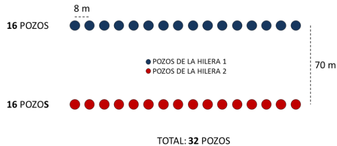
Figura 4.5 Arreglo de pozos en los clústeres de Petroindependencia S.A.
