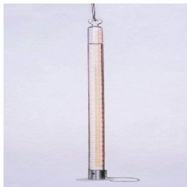
Figura 1.7: Evaporímetro.
