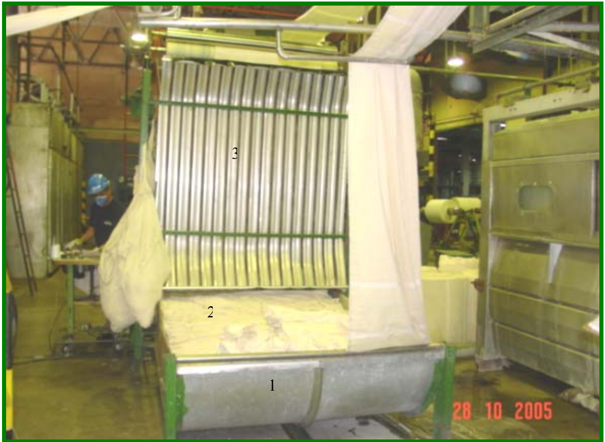
Figura 2. Vista anterior de la batea de acumulación.
