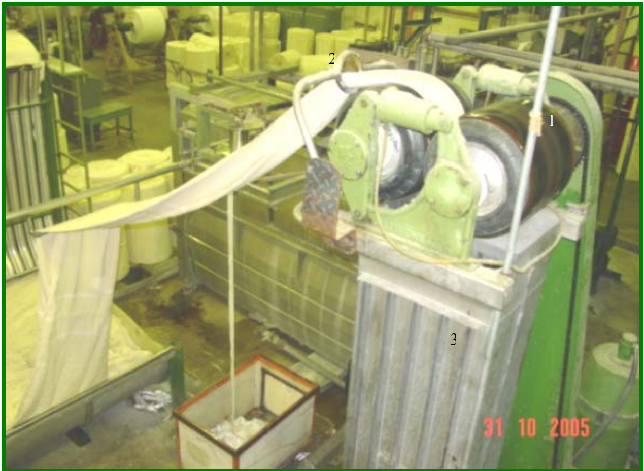
Figura 3. Foulard a la entrada de la tina de impregnación.
