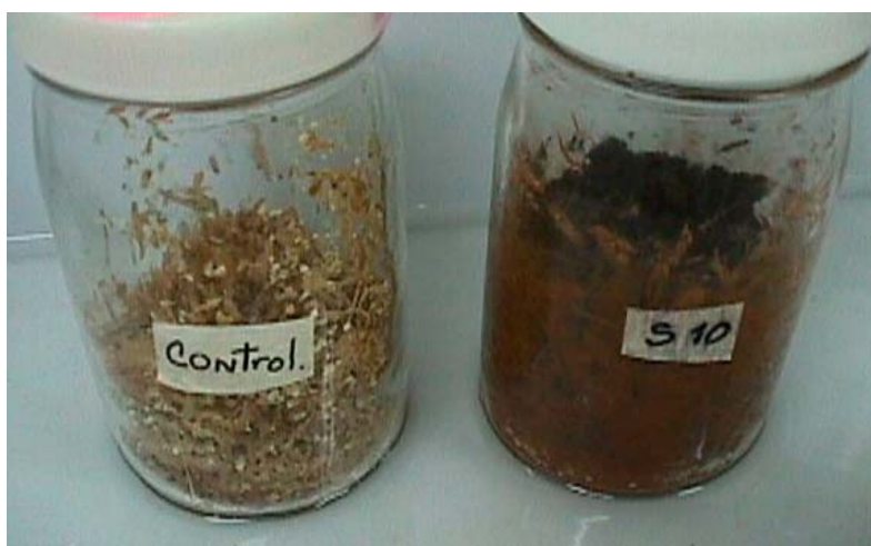
Figura 3.8. Biolixiviación directa: a la izquierda se observa el control del proceso constituido por medio MGC inoculado, a la derecha se encuentra el método directo en fermentación sólida.
